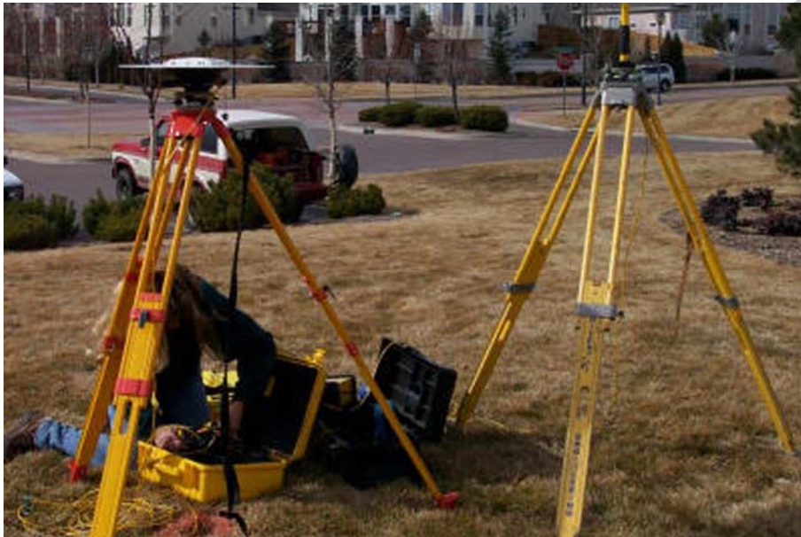
4. ábra Geodéziai GPS vevők 4
