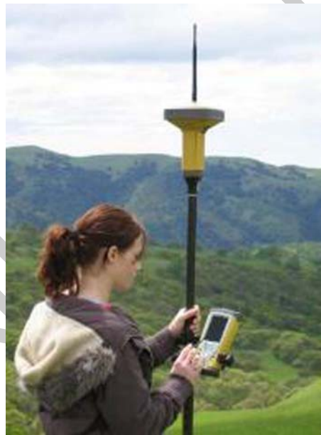
6. ábra GPS vevő antennarúdon 6
