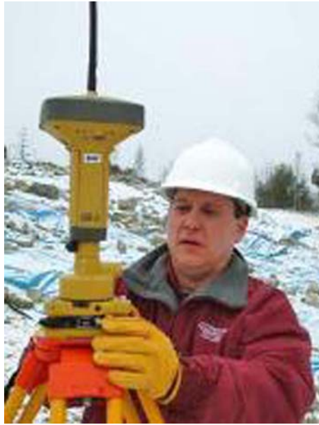
5. ábra GPS vevő műszerállványon 5
