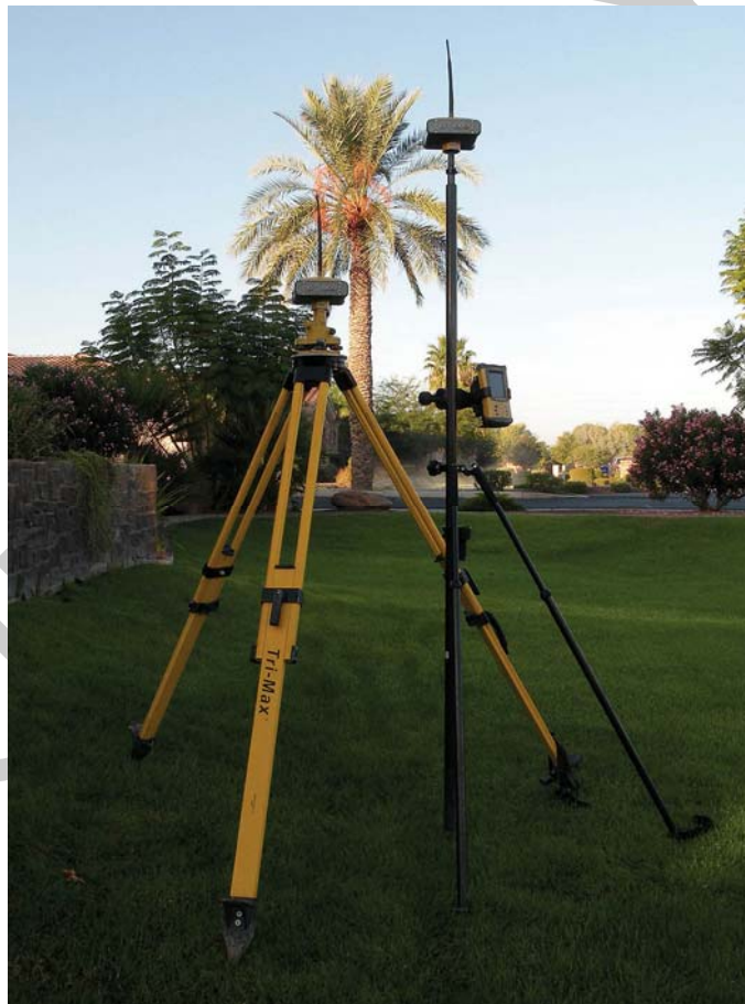
5. ábra GPS vevő műszerállványon és antennarúdon 5
