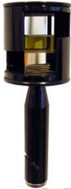
2. ábra Szögprizma, a derékszögű részletmérés fő eszköze 2
