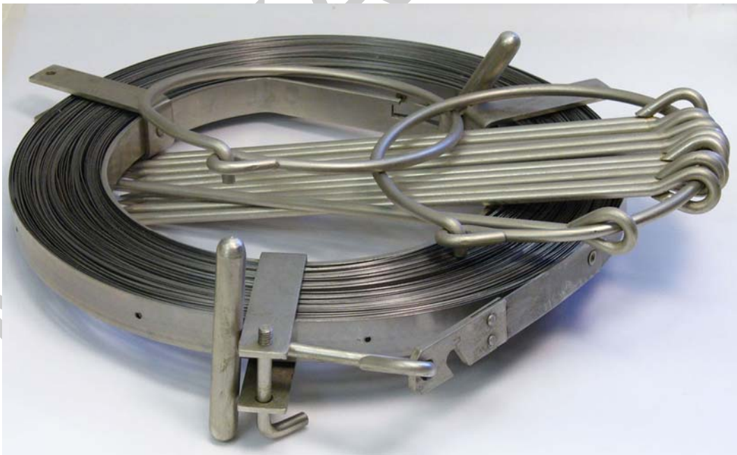
3. ábra Keretes mérőszalag, elsősorban az abszcisszák meghatározásához 3
