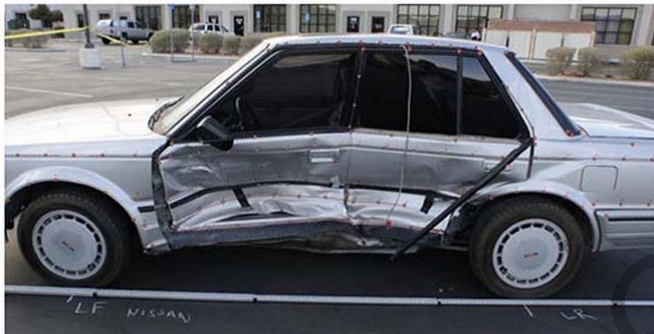
4. ábra. Karambolos autó vezetőoldali sérüléseinek felmérése földi fotogrammetriával 4
