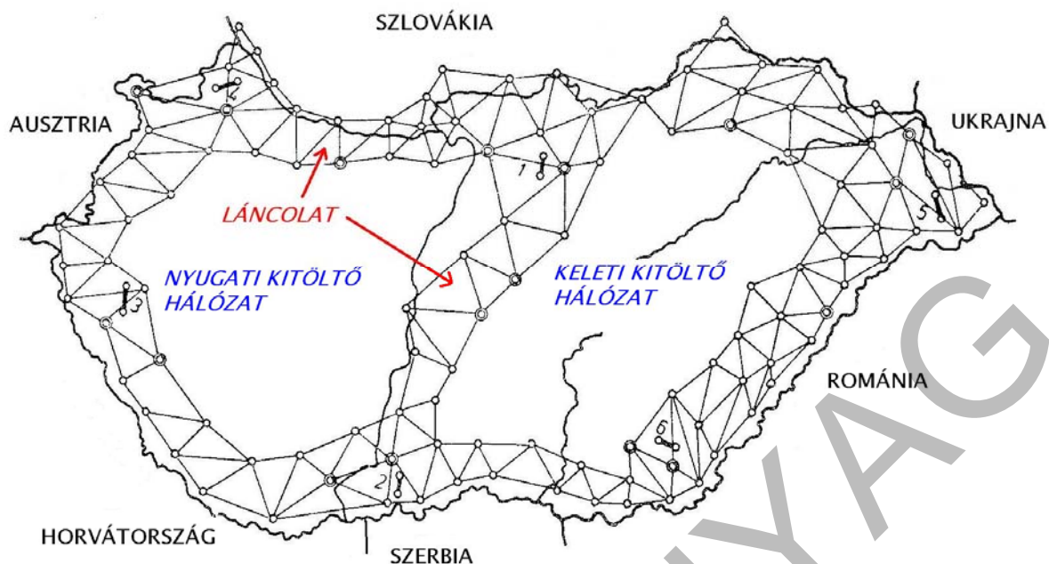
3. ábra. A magyarországi felsőrendű vízszintes alappont-hálózat felépítése
