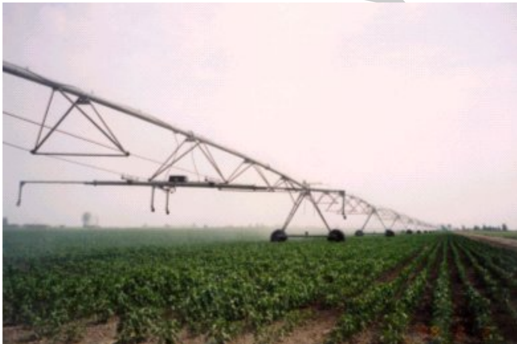
18. ábra Lineár öntözőberendezés paprika táblában 17
