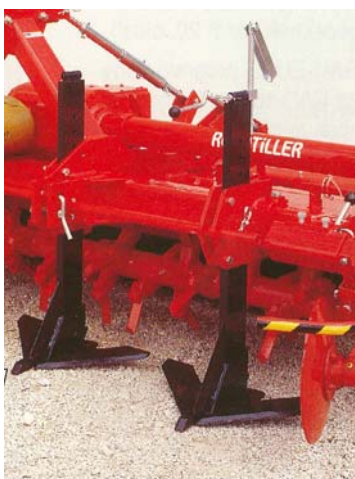
3. ábra: Kultivátor művelőtestei: lúdlábkapák
