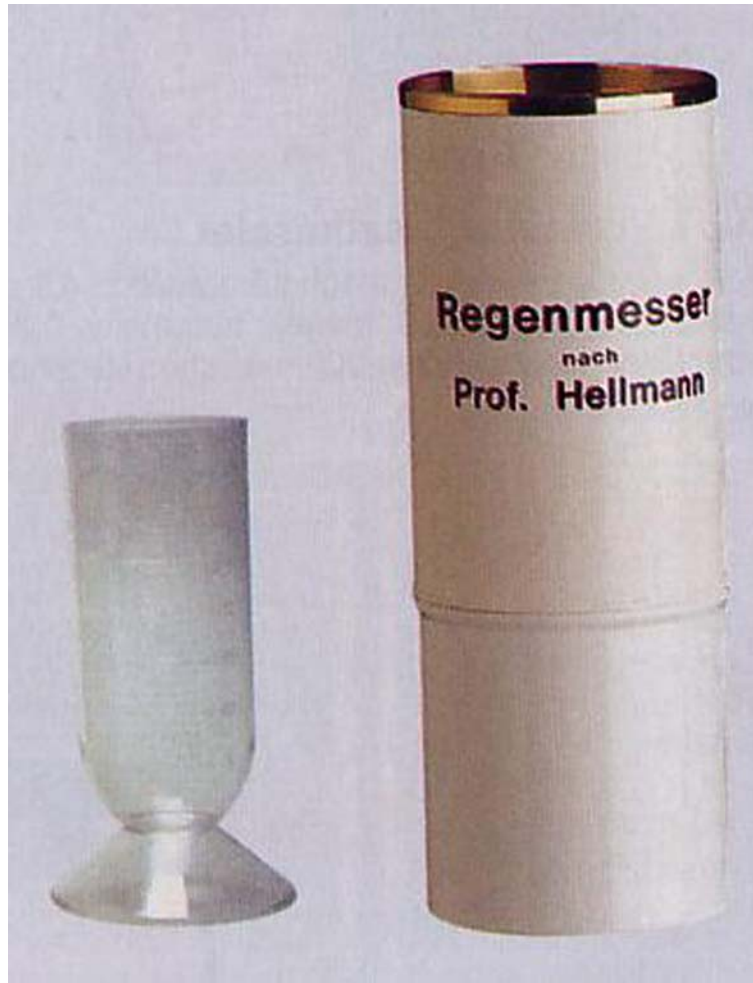
11. ábra. Hellmann-féle csapadékmérő
