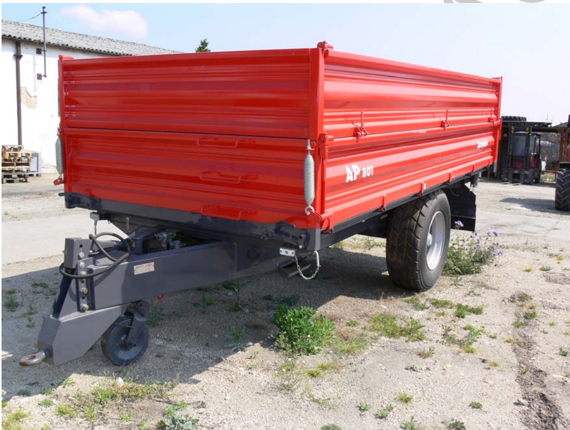
12. ábra. Szabályos oldalfalakkal ellátott pótkocsi
