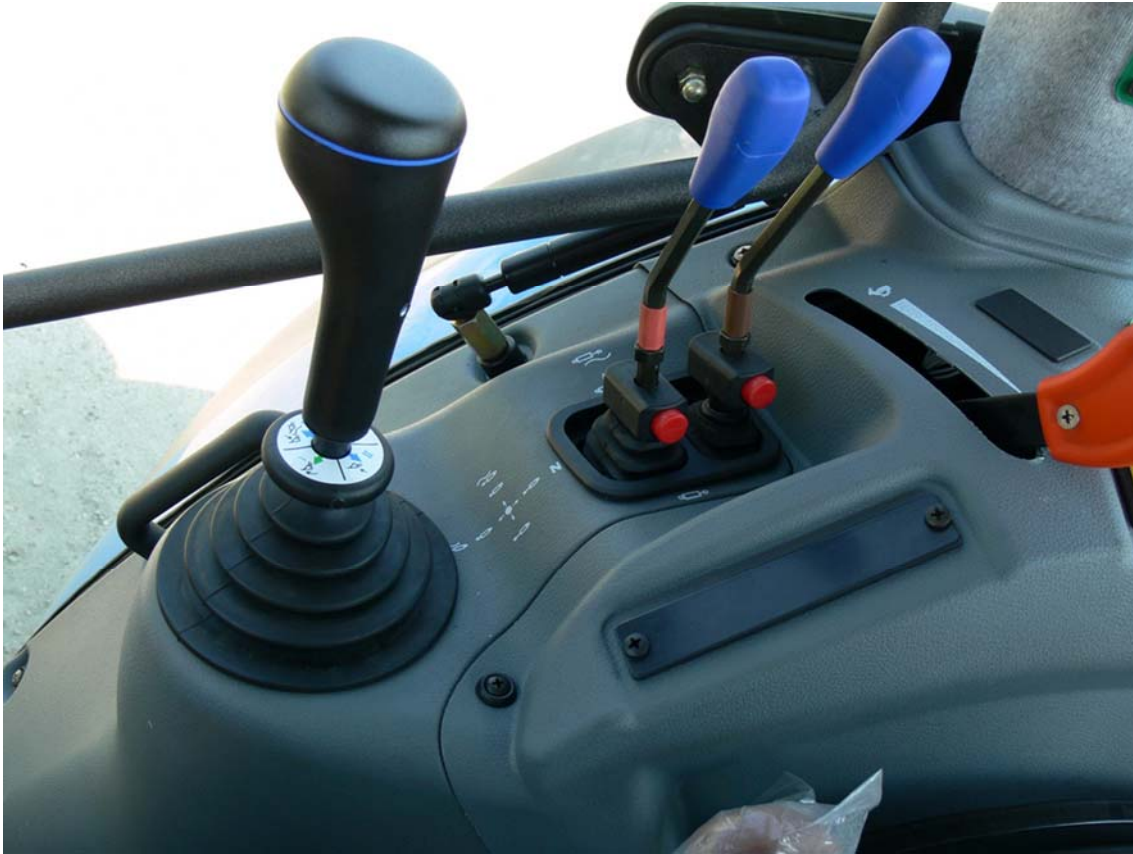
6. ábra. Ergonómiai szempontok figyelembevételével tervezett kezelőelemek
