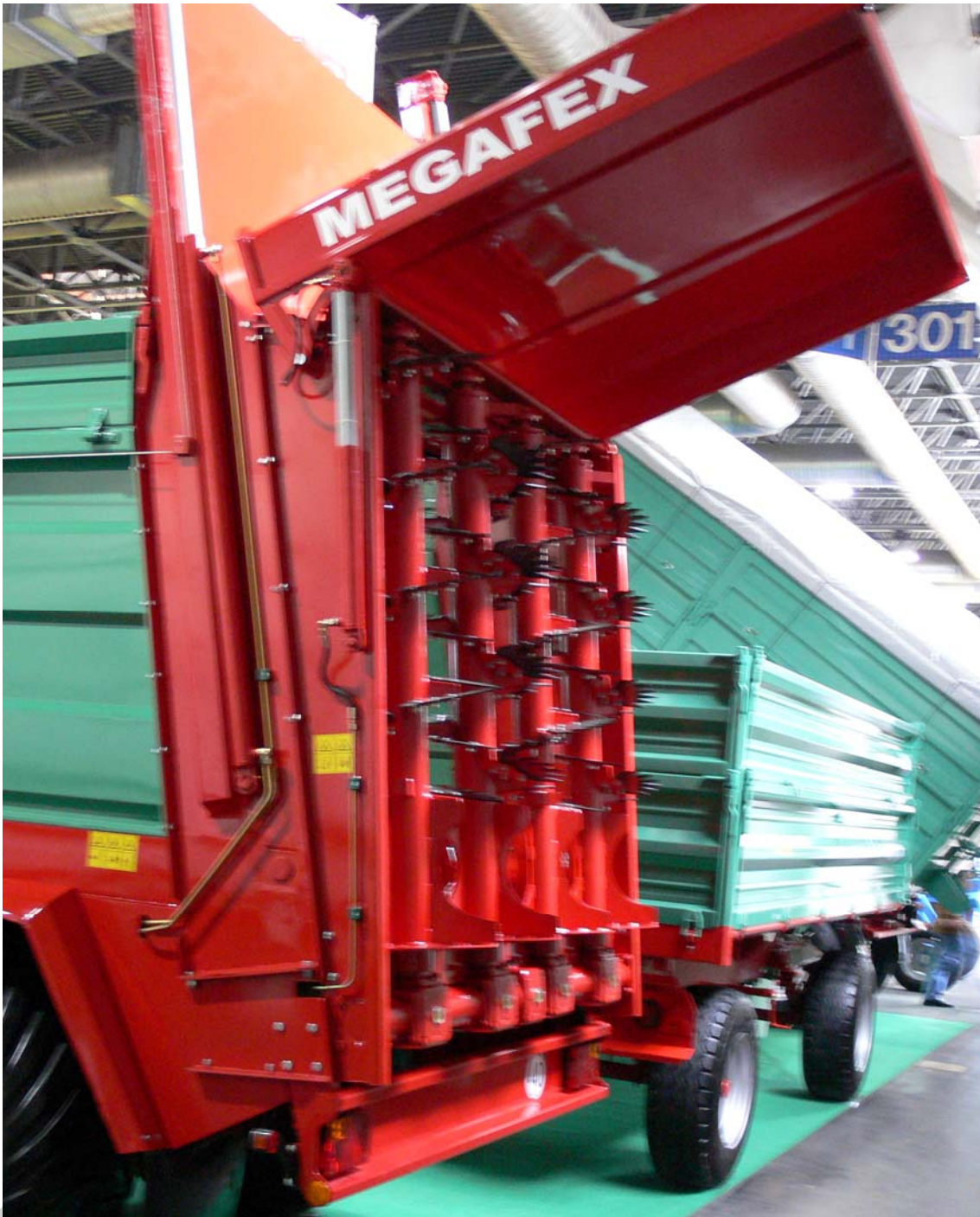
16. ábra. Zárható tépőszerkezet szerves-trágyaszórón
