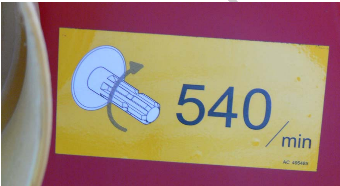
17. ábra. Szabályosan jelzett TLT csatlakozás
