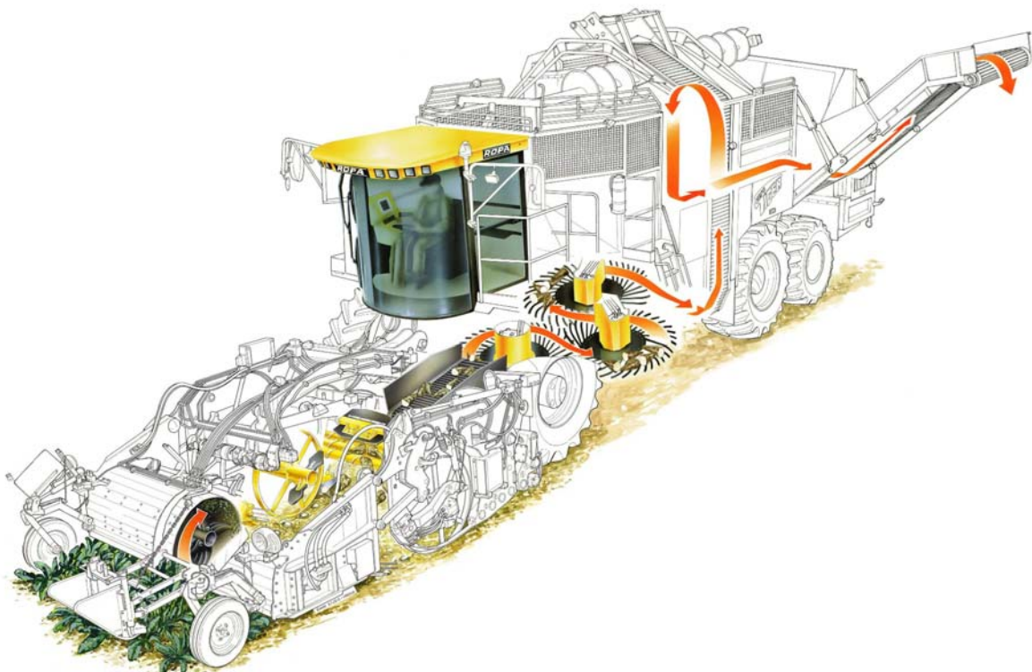
42. ábra Cukorrépa útja a betakarító gépben
