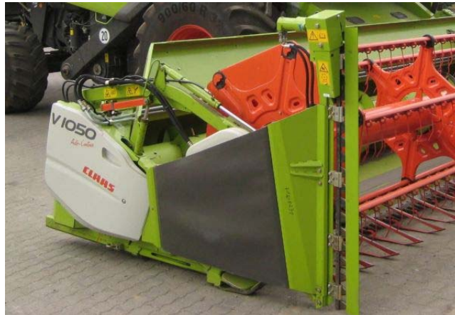
7. ábra Rendválasztó és kalászemelő a vágóasztalon
