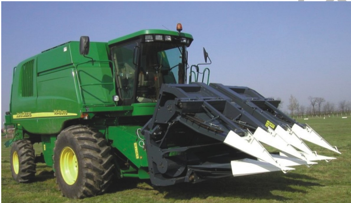
29. ábra Napraforgó adapterrel felszerelt betakarító gép szállítási helyzetben
