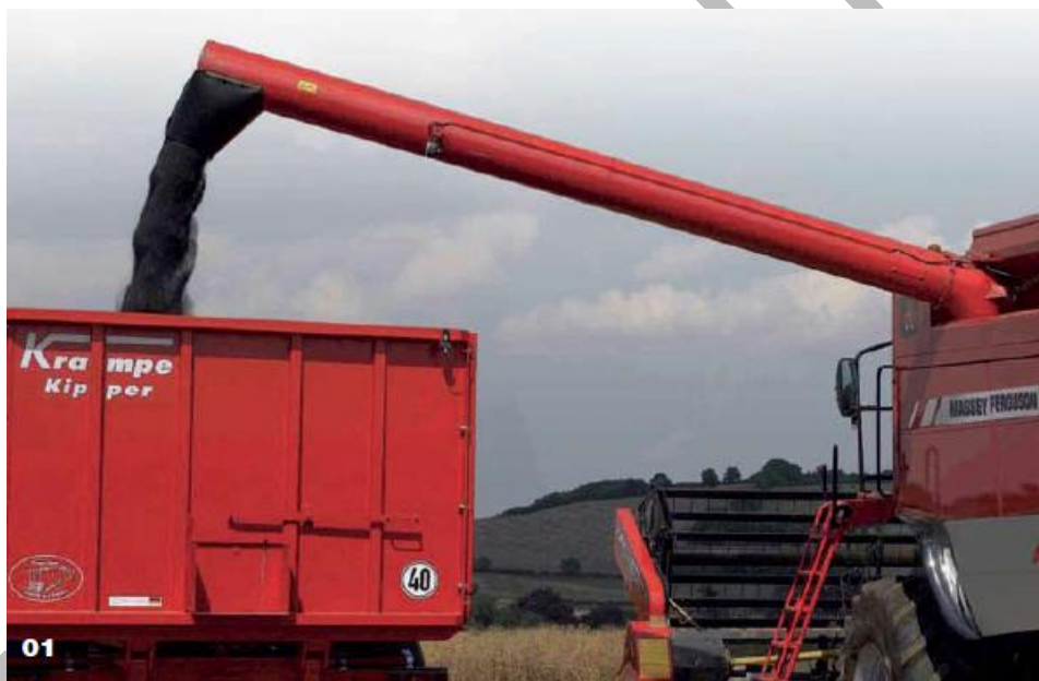
13. ábra Ürítőcsiga üzem közben
