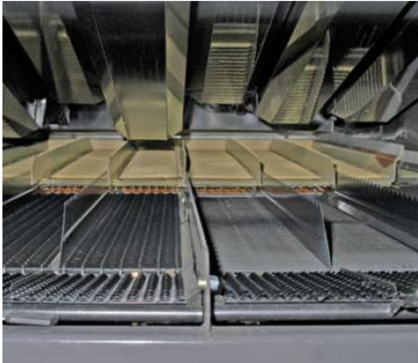
9. ábra Szalmarázó ládák és a rostaszerkezet
