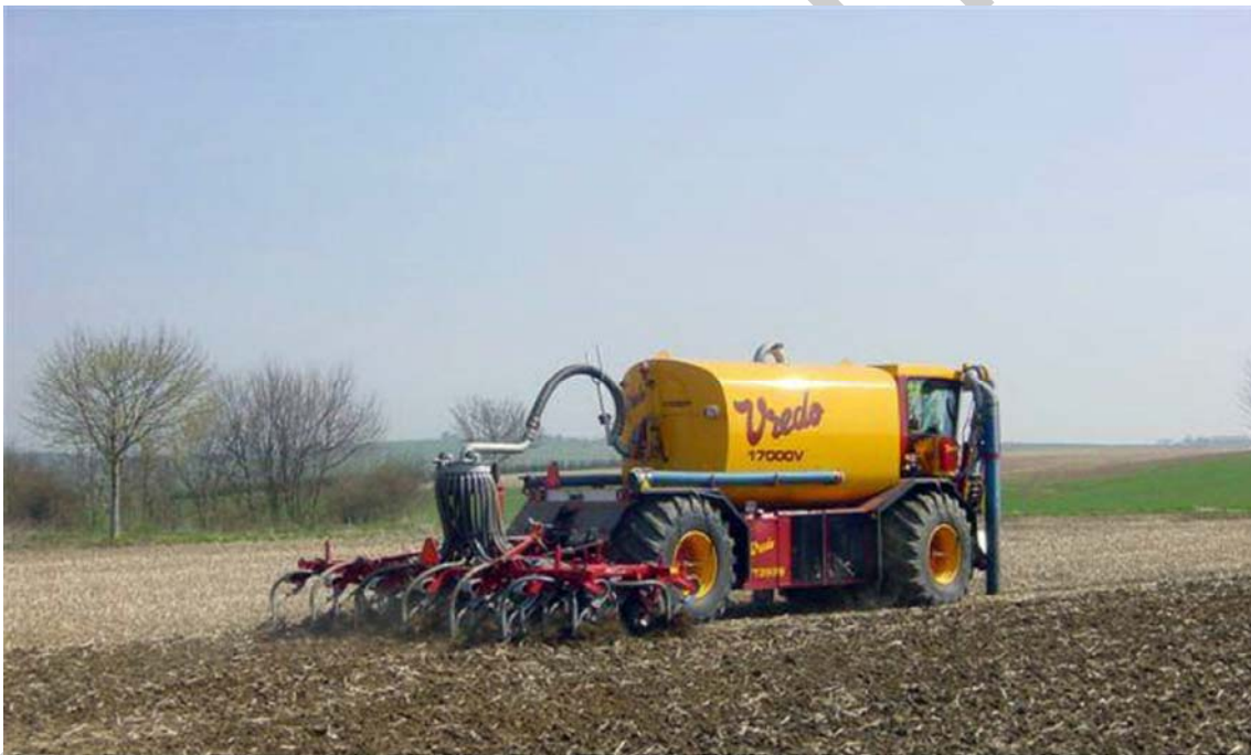
6. ábra Hígtrágya talajba injektálása
