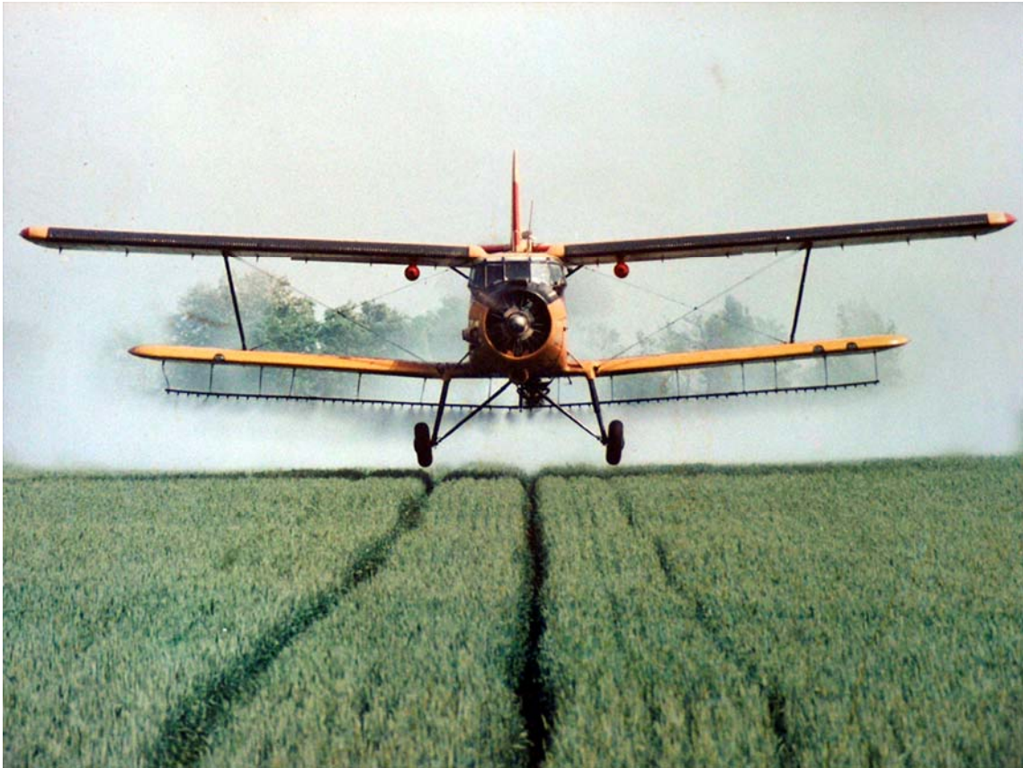
19. ábra Növényvédelemre és tápanyag-utánpótlásra alkalmas repülő
