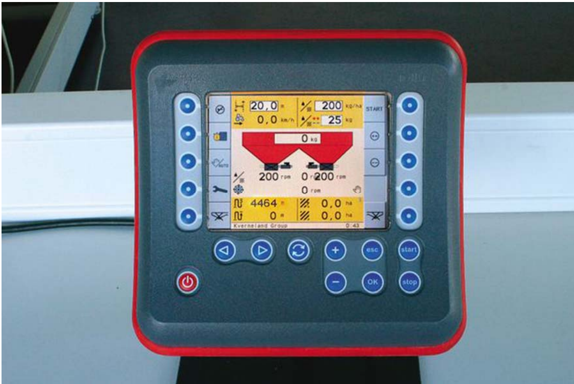
18. ábra Műtrágyaszóró monitor és kezelő felülete
