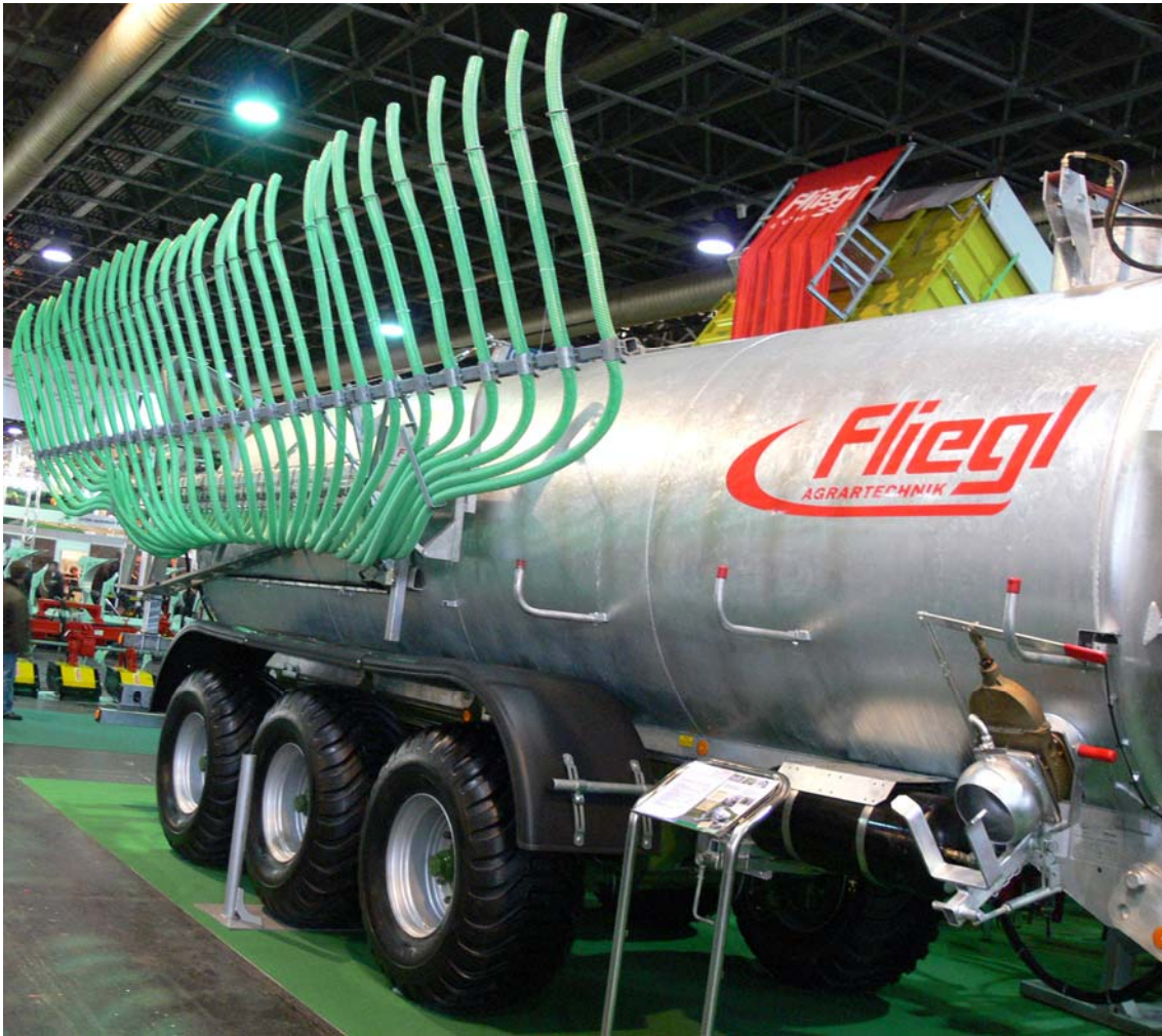
1. ábra Hígtrágya szállít és kijuttató
