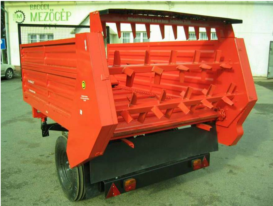
4. ábra Vízszintes kétdobos trágyaszóró
