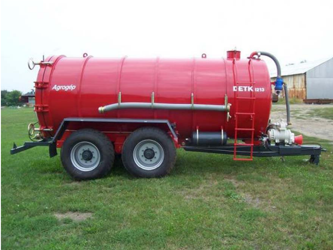
7. ábra Tandem kerekes trágyalé szippantó
