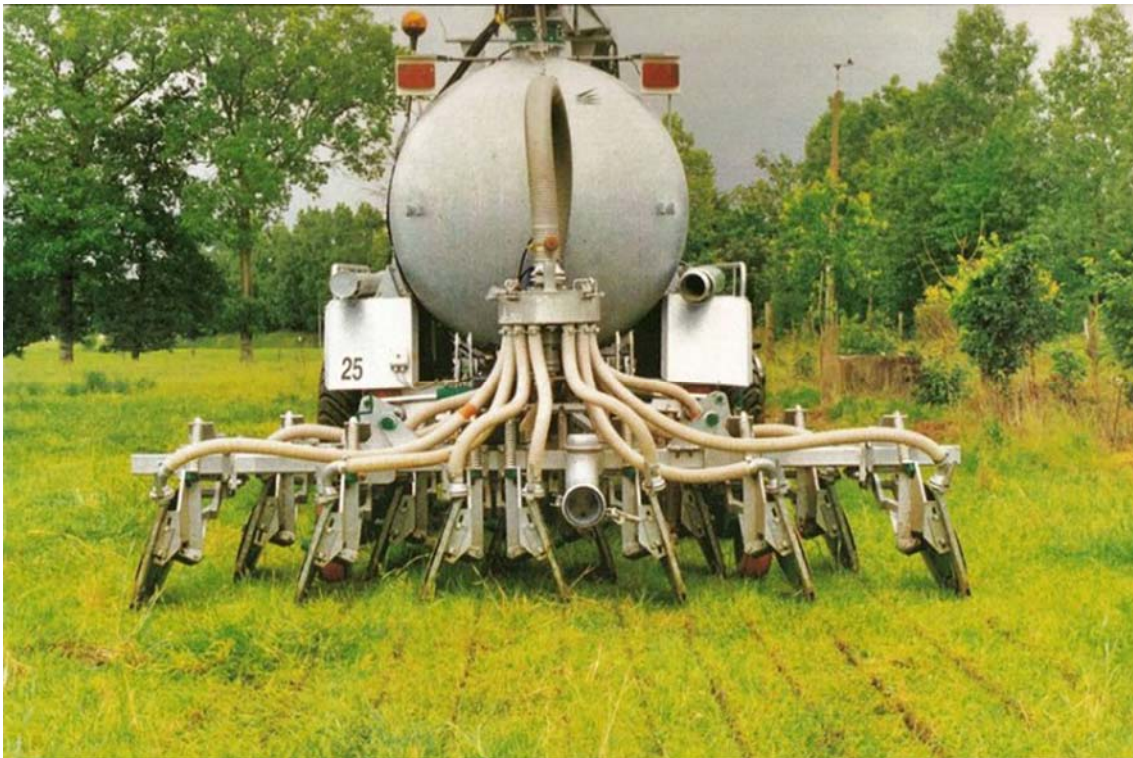
8. Ábra Gyepterületbe injektáló berendezés
