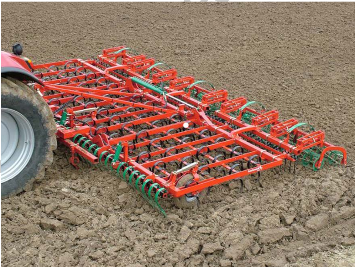
38. ábra Könnyű magágykészítő kombinátor
