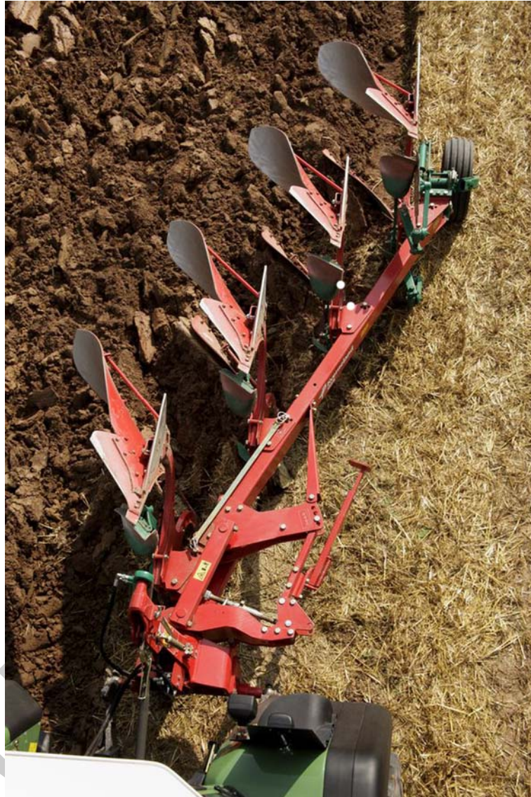
11. ábra Függesztett eke munkában
