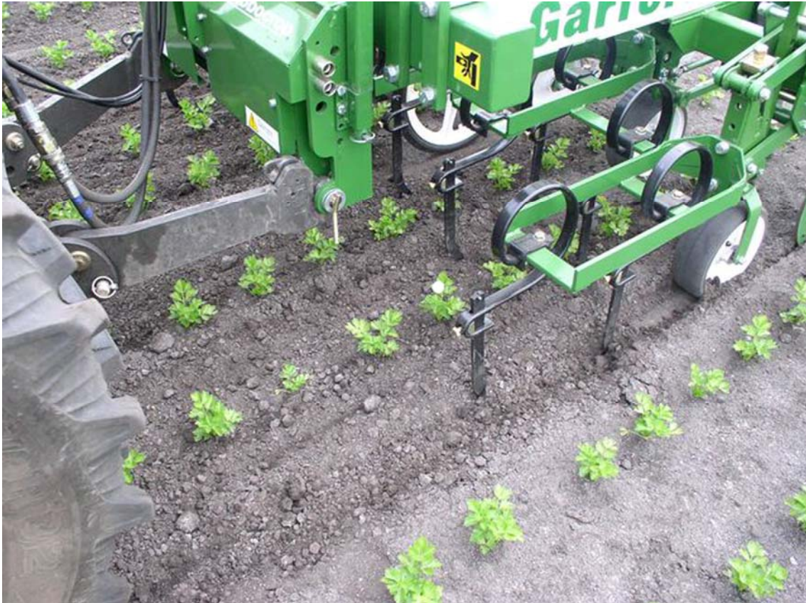
35. ábra Sorközművelő kultivátor csatlakozó sora
