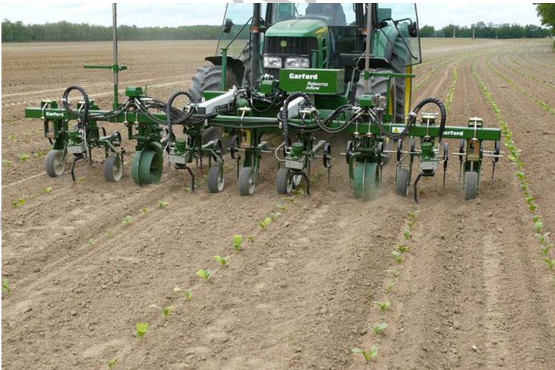
36. ábra Sor és sorköz művelő (tőszám beállító) kultivátor
