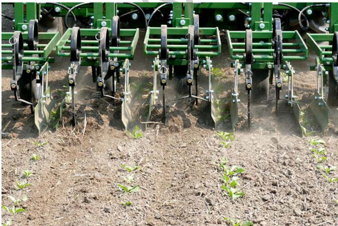
34. ábra Sorköz művelő kultivátor védőlemezzel
