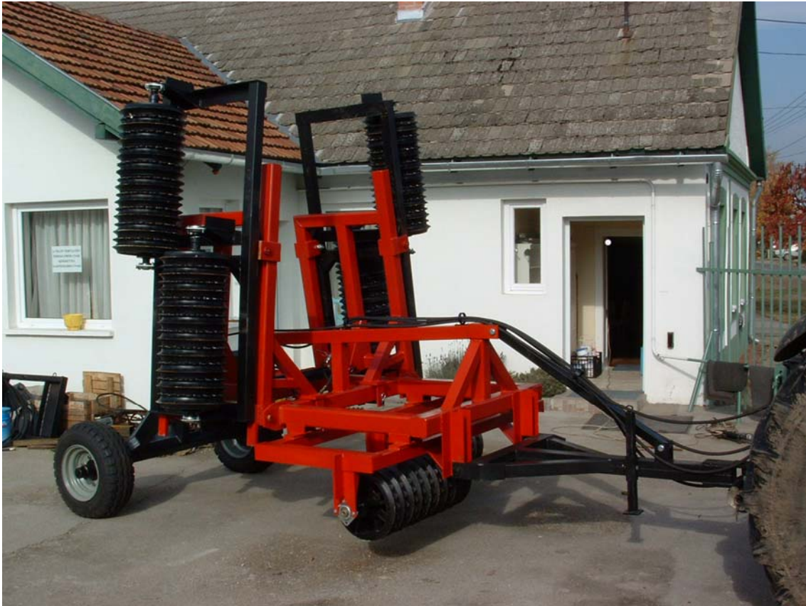
27. ábra Cambell féle tömörítő henger
