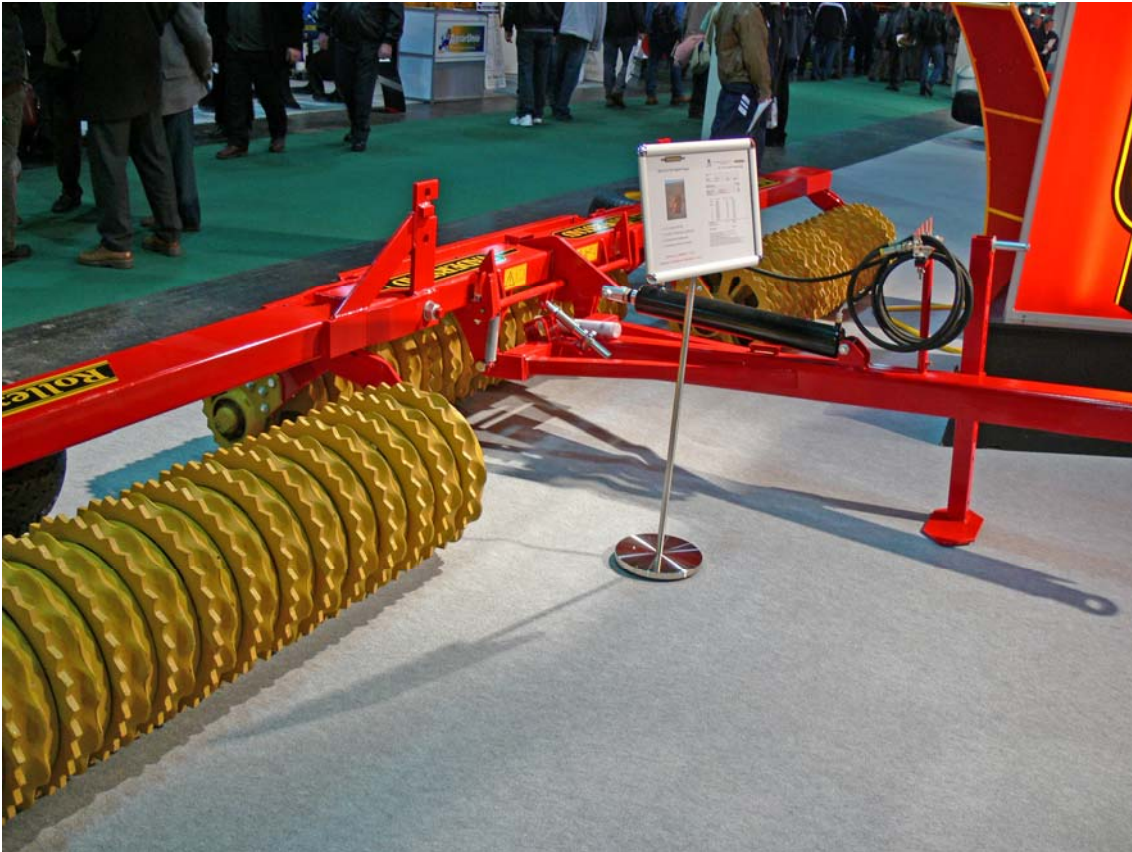
28. ábra Hengerek vonószerkezete
