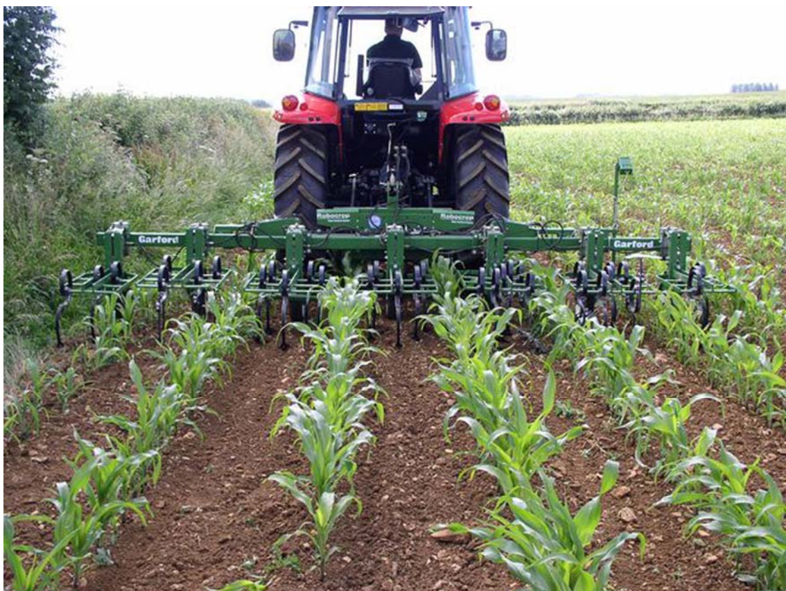
33. ábra Sorközművelő kultivátor kukoricában
