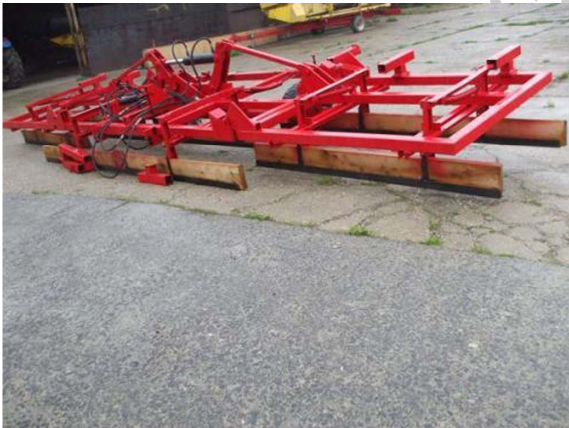
29. ábra Függesztett simító vonókerettel
