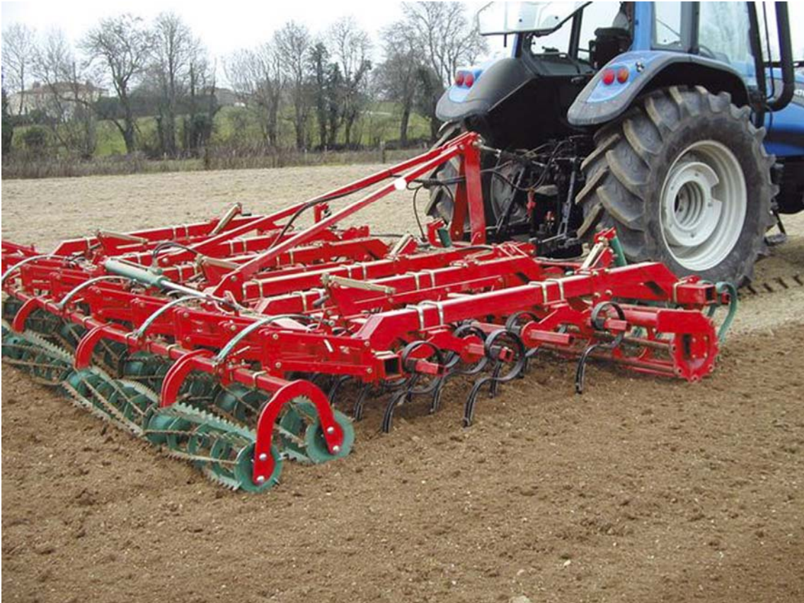
39. ábra Középnéhez magágykészítő kombinátor
