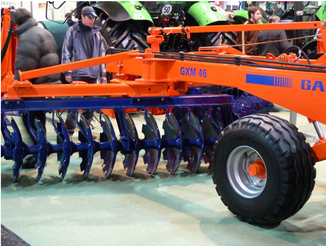
23. ábra X alakban rendezett tárcsatagok csipkézett éllel
