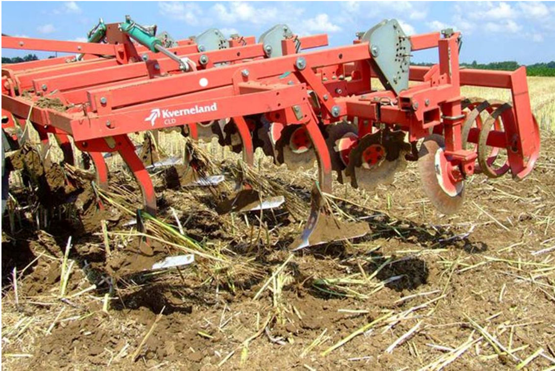
42. ábra Tarlóművelő kombinátor
