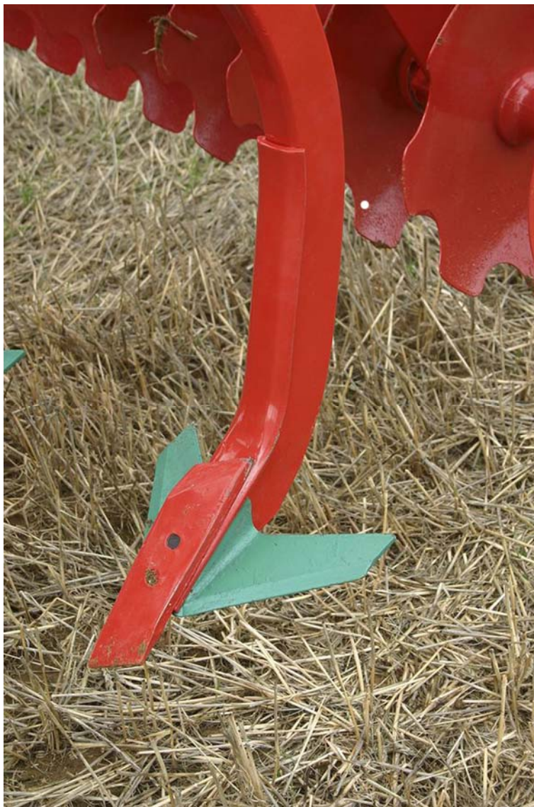
30. ábra Talajlazító szerszám
