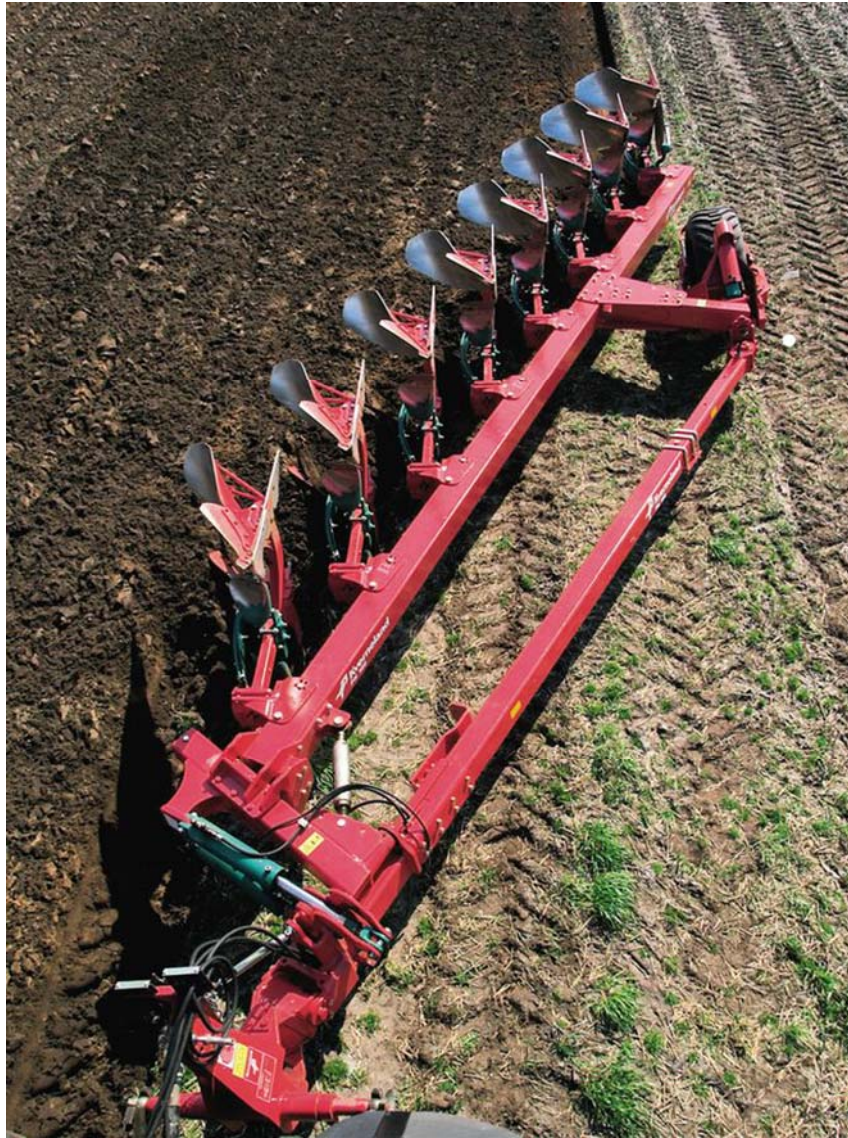
12. ábra Félélig függesztett eke munkában
