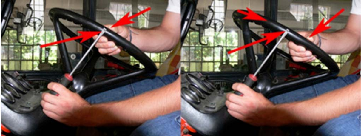
41. ábra Kormányholtjáték egyszerű ellenőrzése
