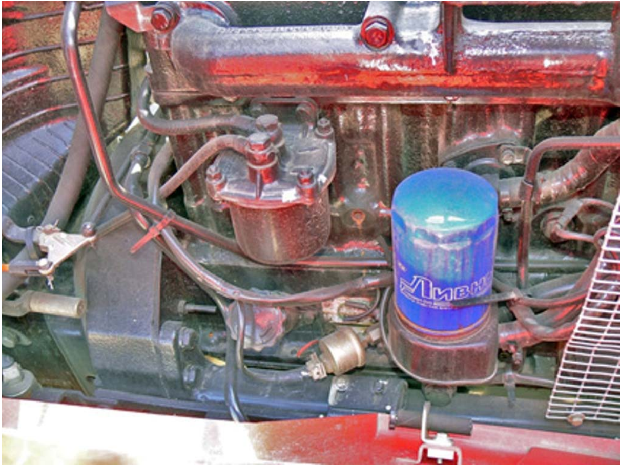
5. ábra Olaj nyomását érzékelő jeladó (olajgomba)
