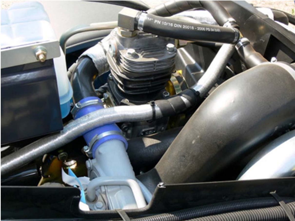
49. ábra Légsűrítő (kompresszor)
