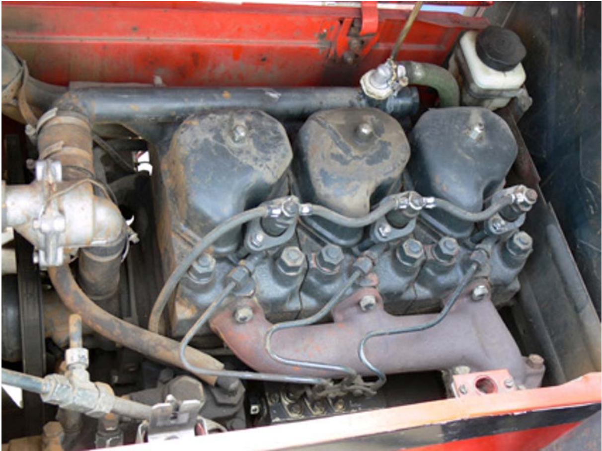
21. ábra Magasnyomású rendszer légtelenítése
