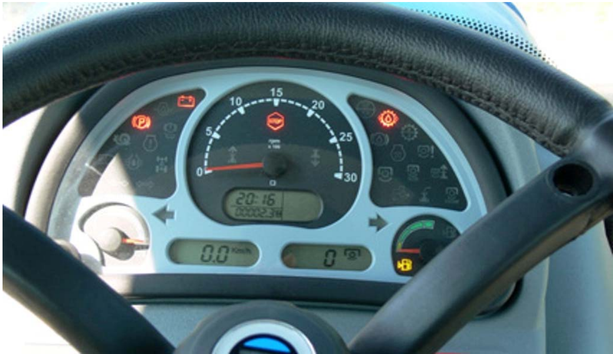
19. ábra Üzemanyag mennyiségének ellenőrzése jelzőműszer segítségével
