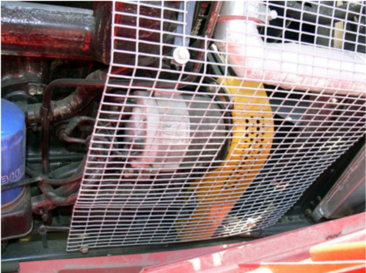
14. ábra Ékszíj feszítése a generátor elmozdításával
