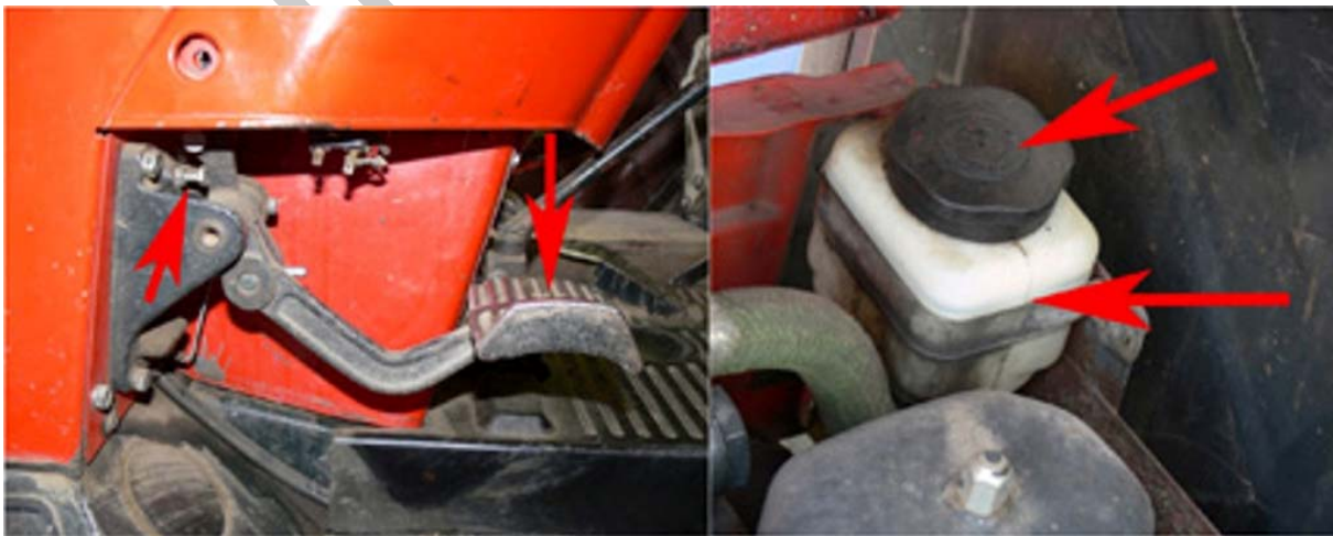
34. ábra Tengelykapcsoló pedál és működtető folyadék ellenőrzése
