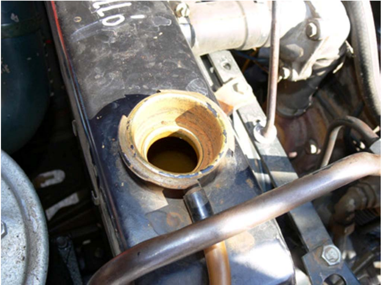
10. ábra Nyitott hűtési rendszer ellenőrzése
