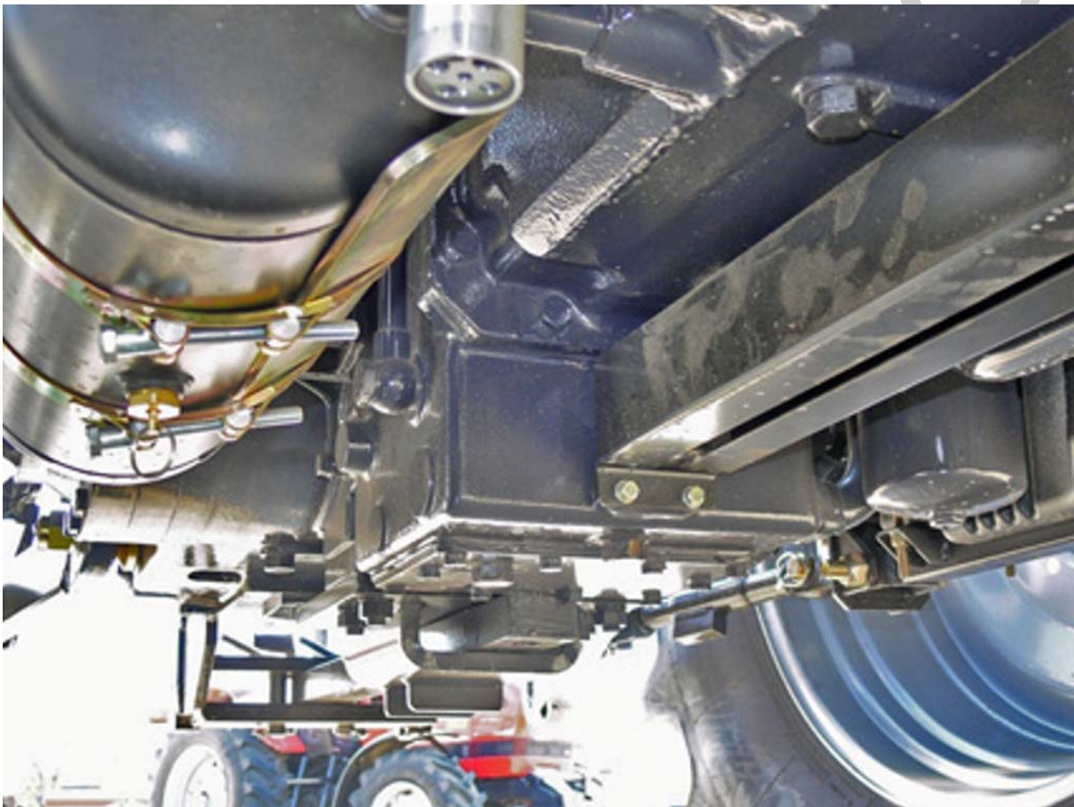
35. ábra Hajtómű (nyomatékváltó) olaj leeresztő nyílásai és olaj szűrője
