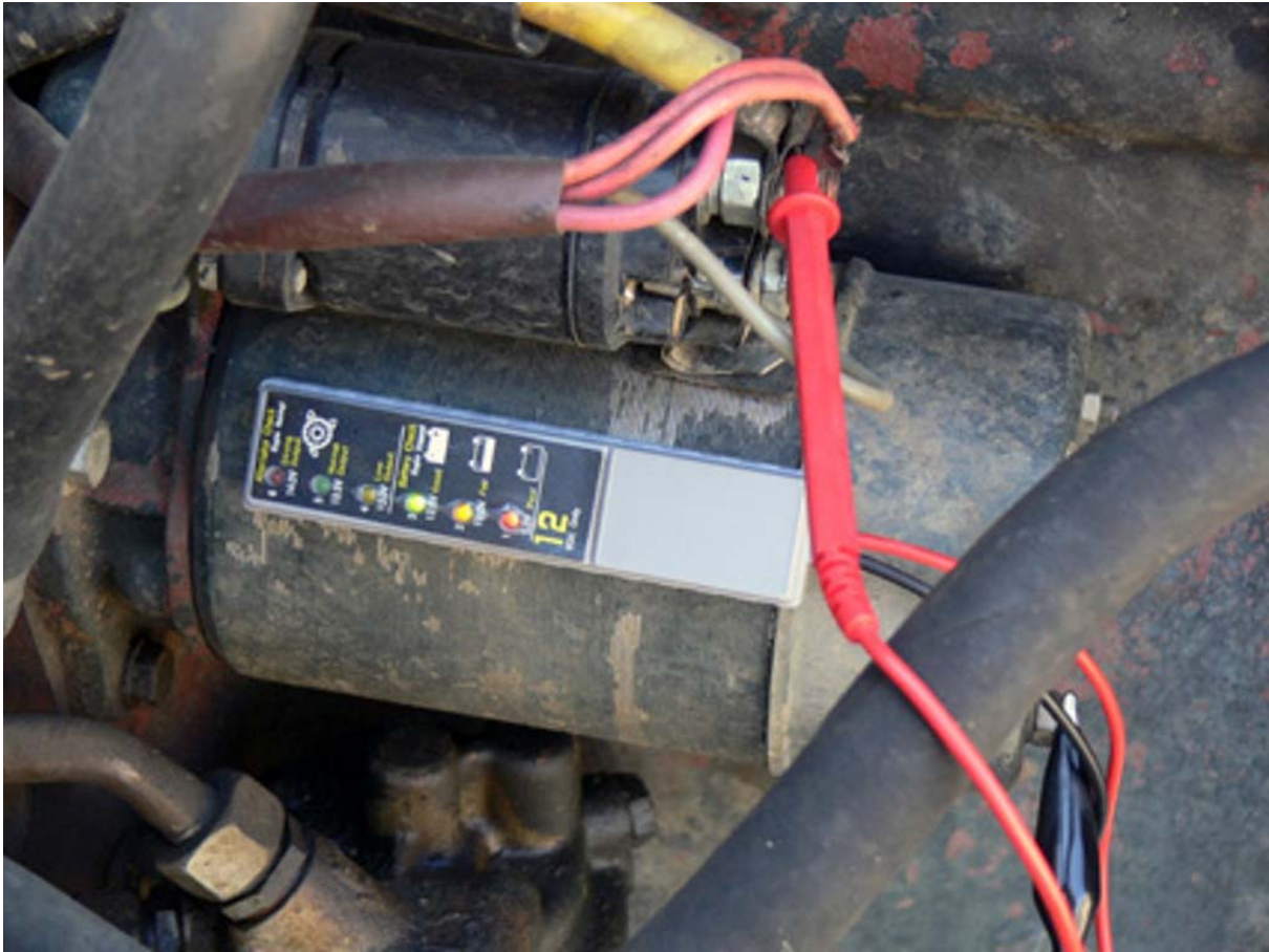
25. ábra Akkumulátor feszültségének egyszerű ellenőrzése
