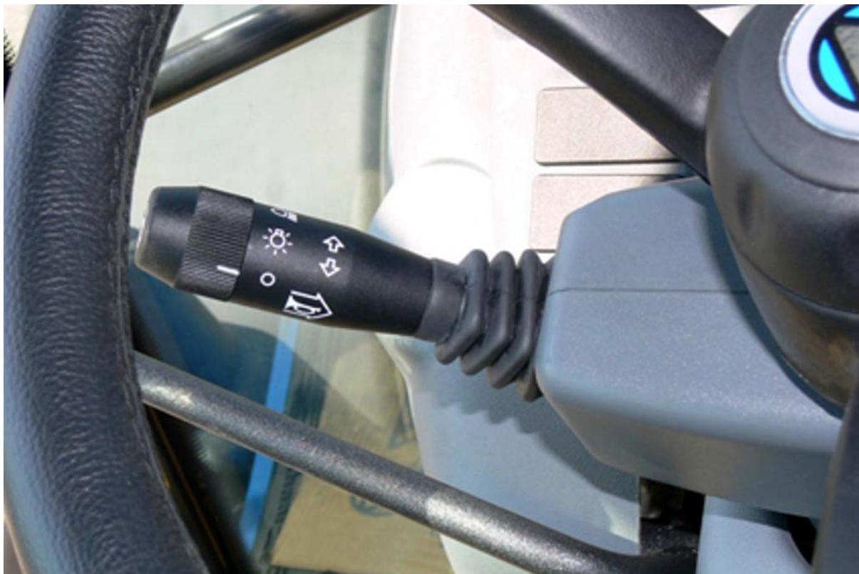
31. ábra Világítás főkapcsoló
