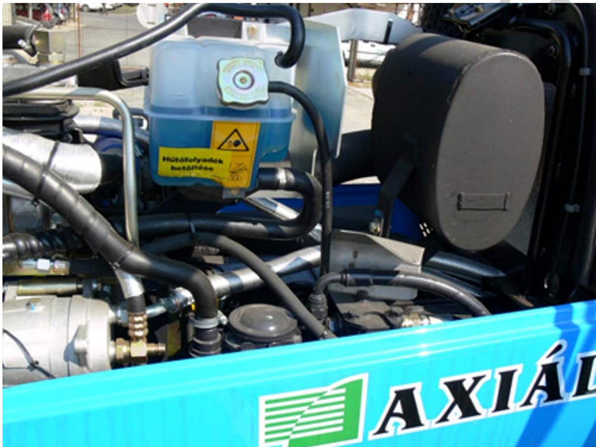
9. ábra Hűtőfolyadék szintjének ellenőrzése
