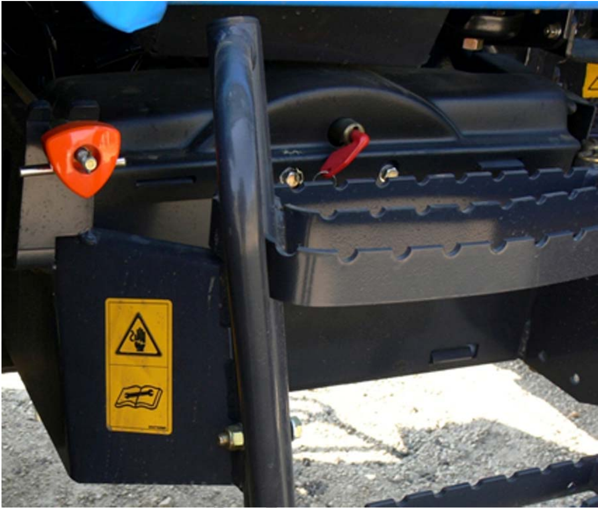
29. ábra Áramtalanító főkapcsoló
