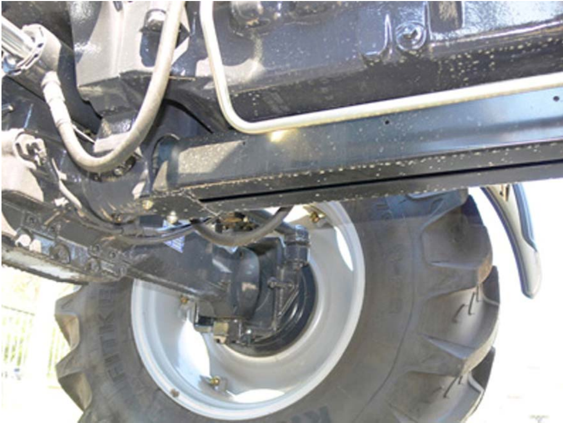
28. ábra. Hidraulikus kormányzás elemei
