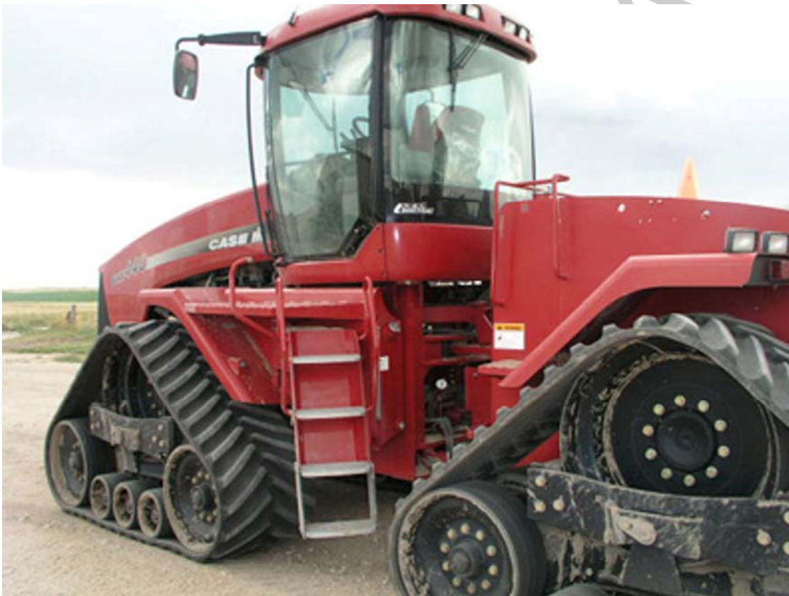
30. ábra. Osztott lánctalppal rendelkező traktor
