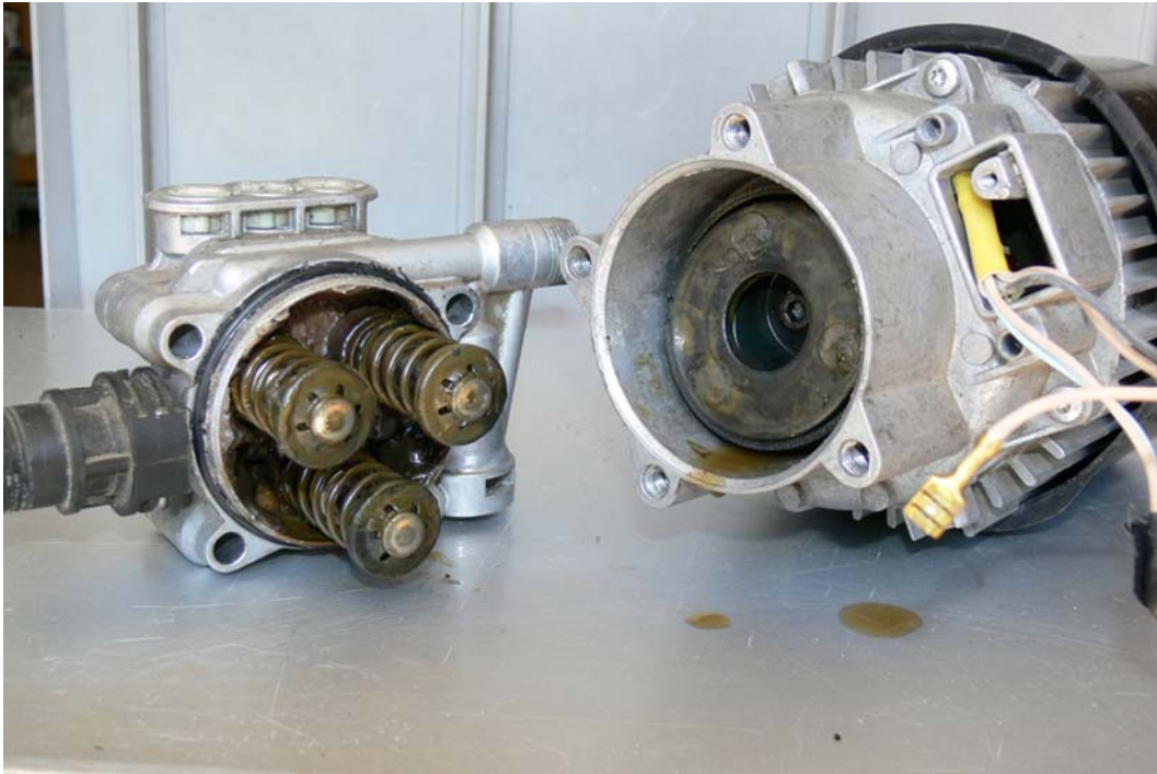
6. ábra Szivattyú és hajtómotor szétválasztása, billenő csapágyas dugattyú mozgató hajtómű
