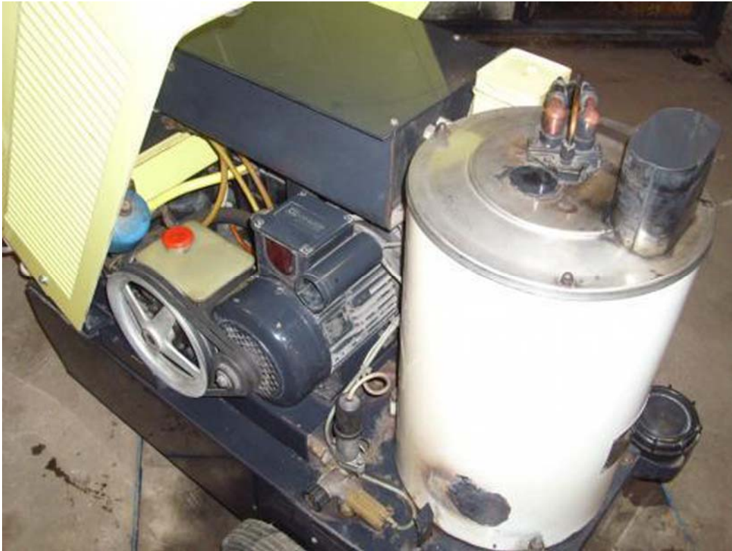
12. ábra Magasnyomású mosó vízhevítő kazánja
