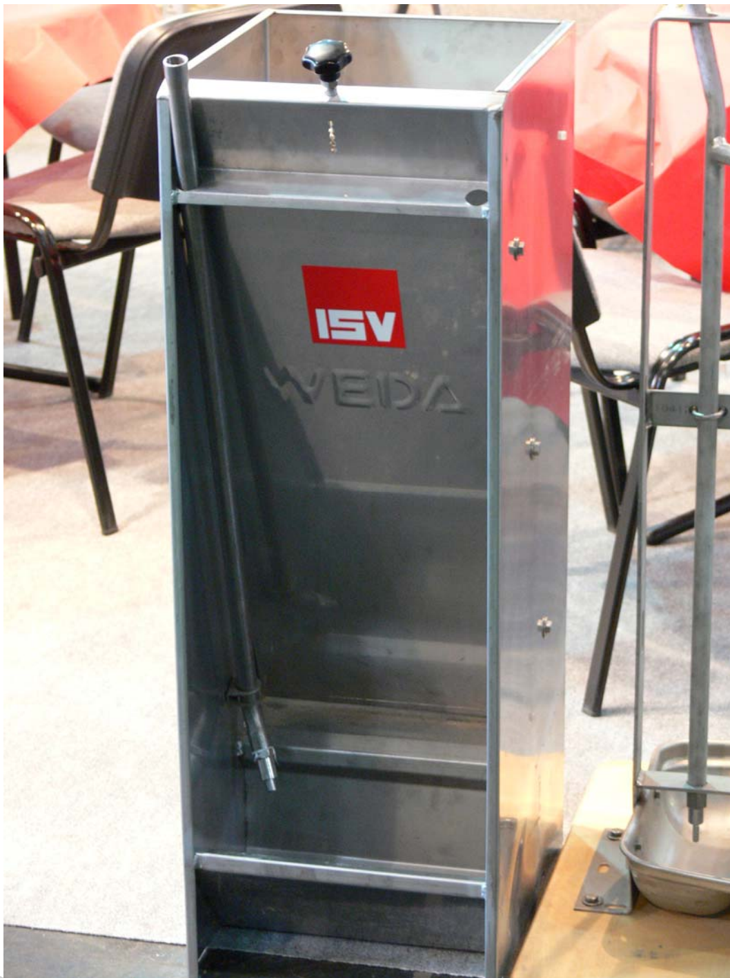
46. ábra Önetetővel kombinált szopókás önitató
