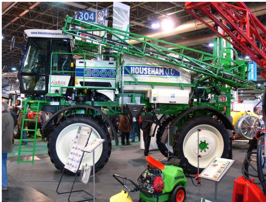
8. ábra Önjáró permetezőgép
