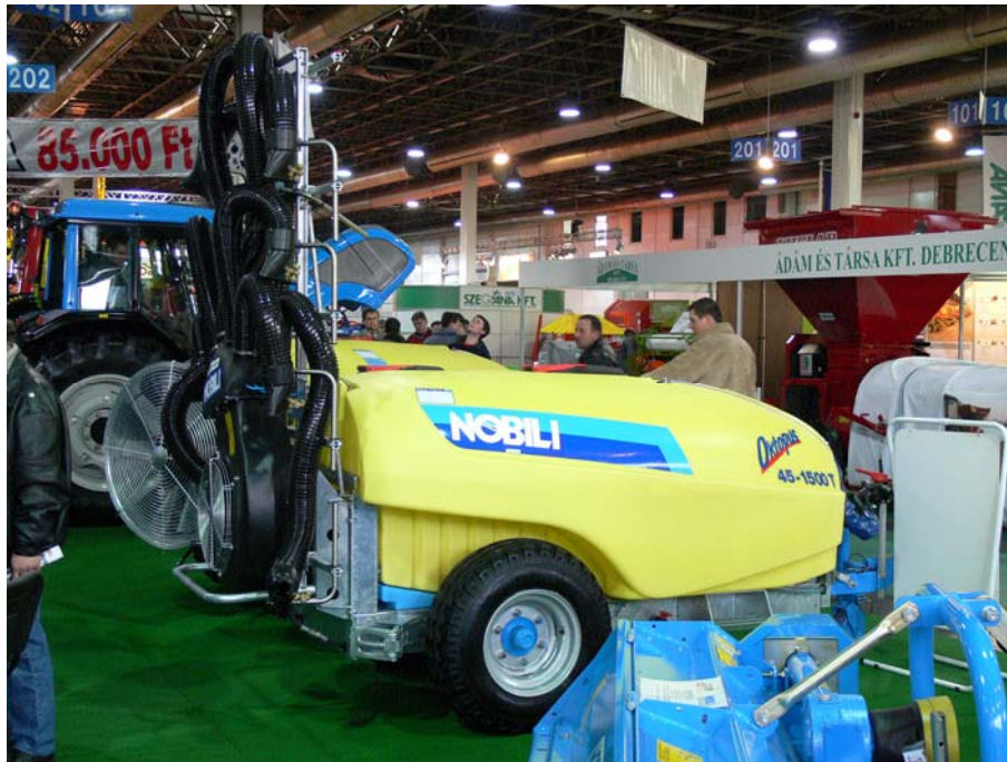
24. ábra Légporkasztásos szórófejekkel szerelt permetezőgép
