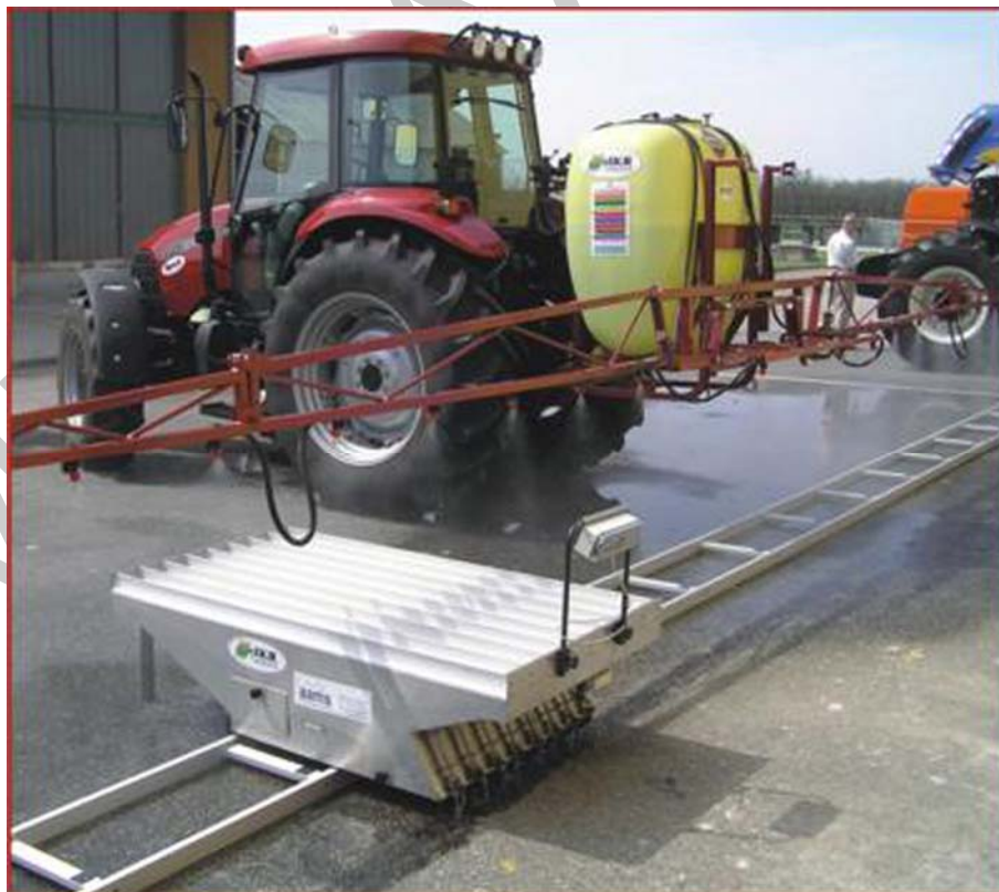
30. ábra Szóró keret szóráskép vizsgálata
