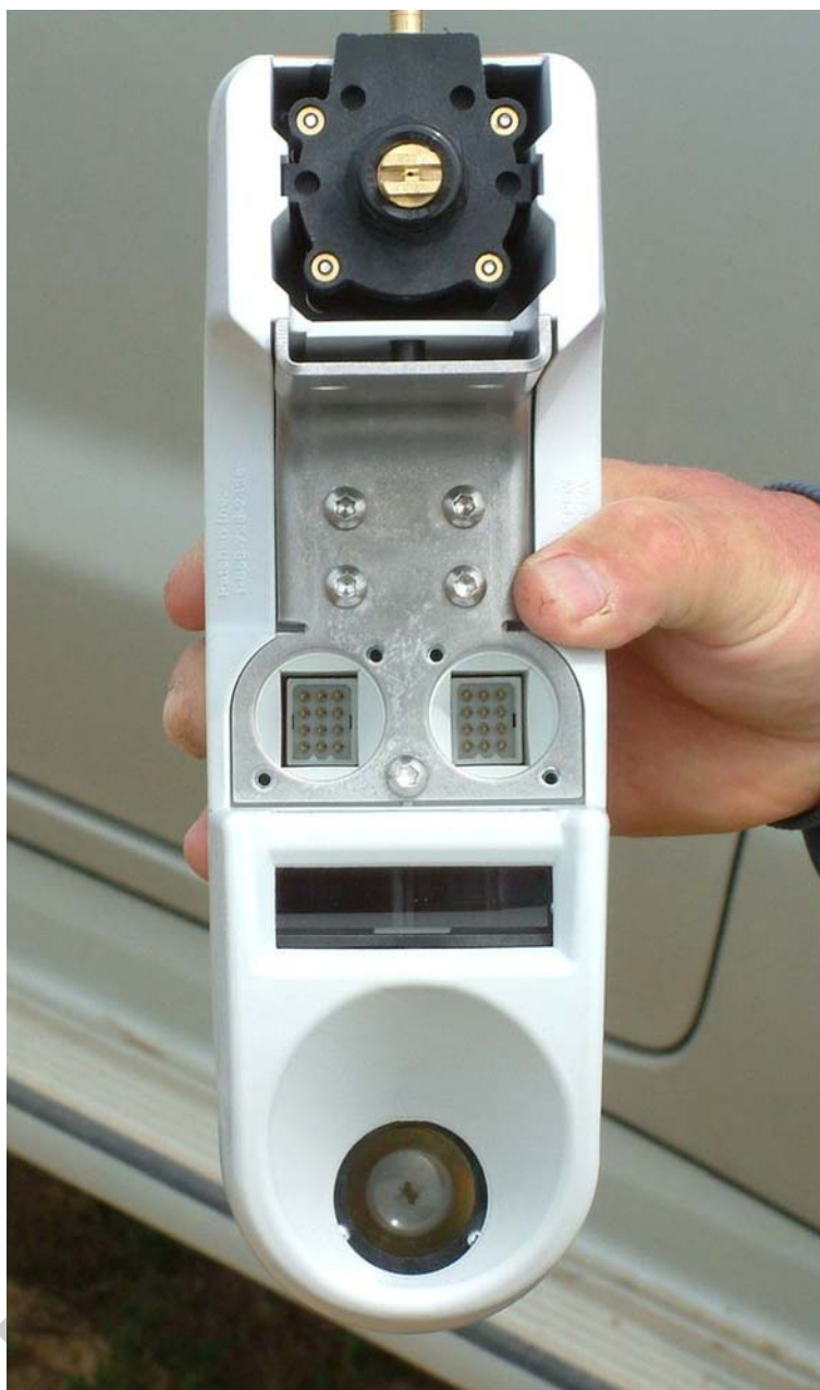
28. ábra Szín érzékelővel (zöld) felszerelt elektronikusan vezérelt szórófej
