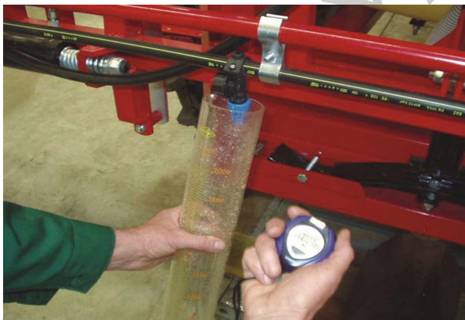
29. ábra Szórófej teljesítmény ellenőrzése
