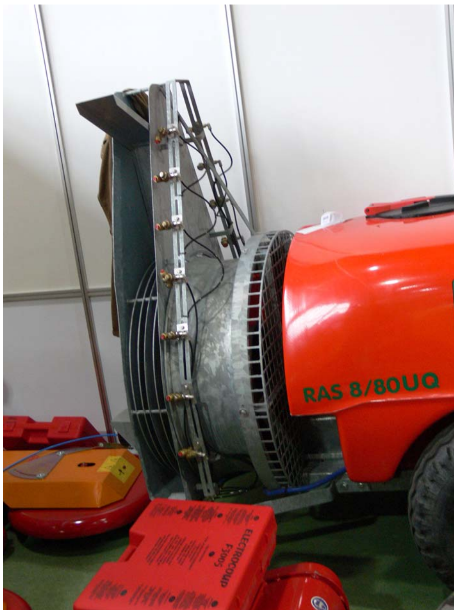
23. ábra Fa és szőlő védelmi szóró keret axiál ventilátorral
