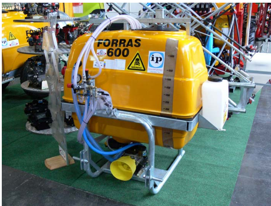
18. ábra Csővezetékek függesztett szántóföldi permetezőgépen
