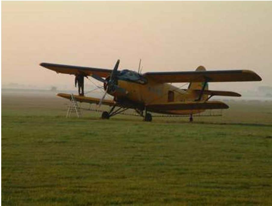
33. ábra Merevszárnyú növényvédős repülőgép
