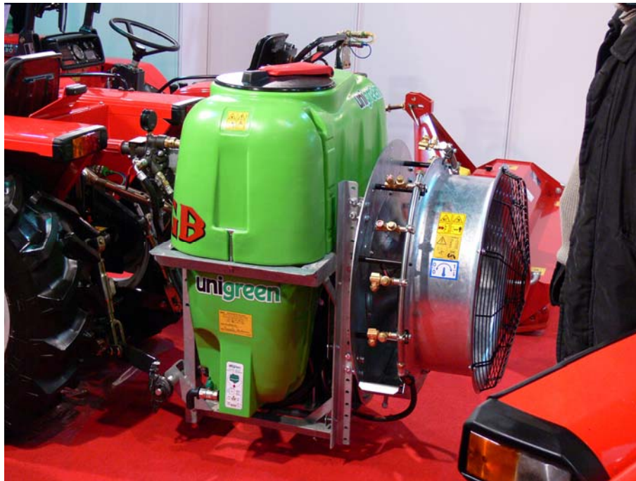
21. ábra Axiál ventilátoros szórókeret
