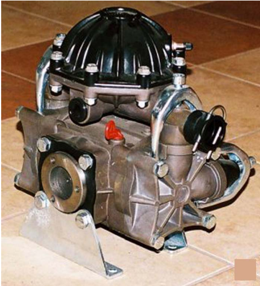
16. ábra Szivattyúval egybeépített légüst
