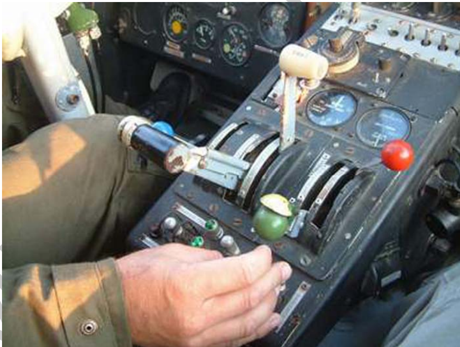
34. ábra A repülő permetező kezelőpanel
