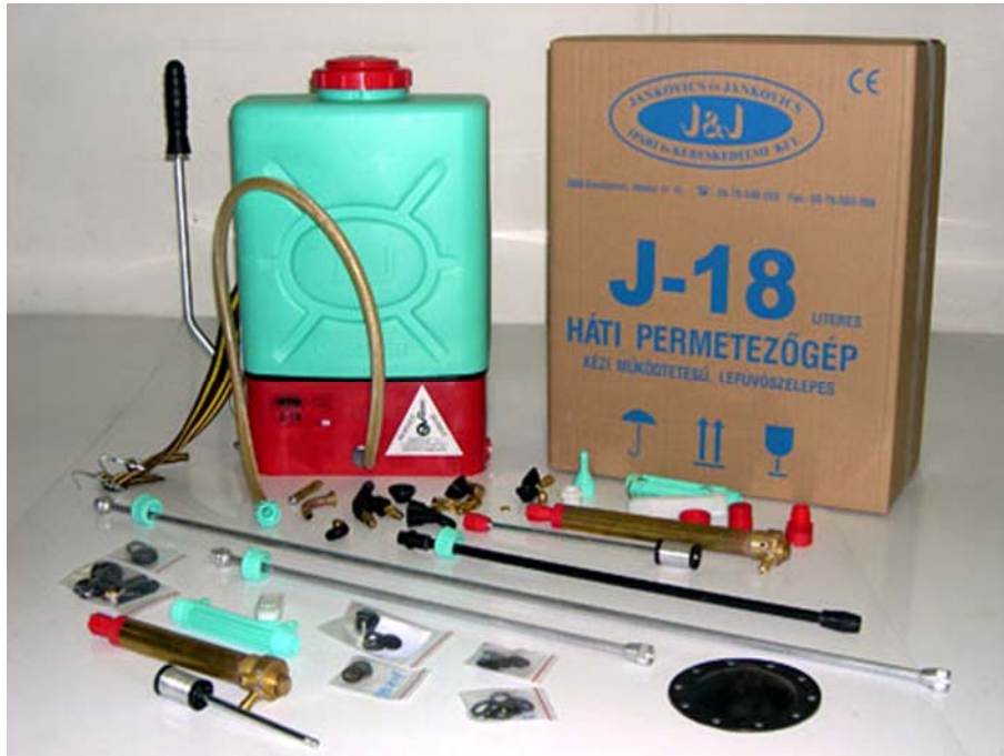
6. ábra Háti permetezőgép és alkatrészei
