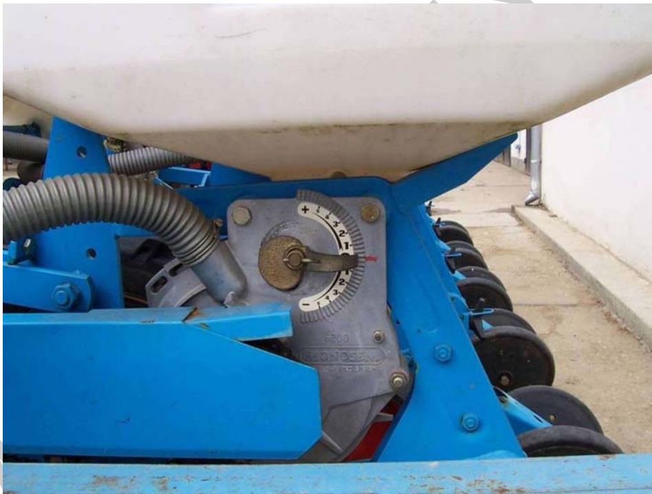
19. ábra. MONOSEM szemenkénti vetőgép, maglesodró állítása
