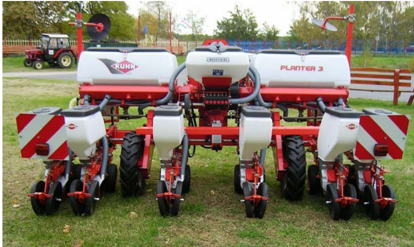
31. ábra. Szemenkénti vetőgép, hidraulikusan állítható szállítási helyzet
