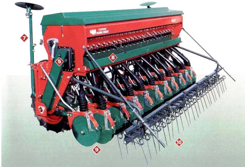
4. ábra. Gabonavető gép, szerkezeti felépítése
