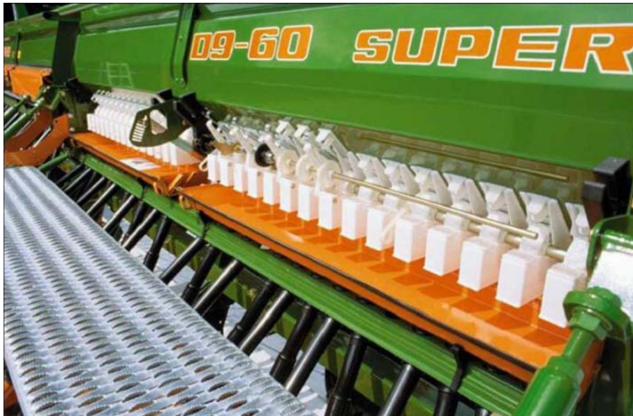
5. ábra. Tolóbütykös vetőszerkezetű gabonavető gép
