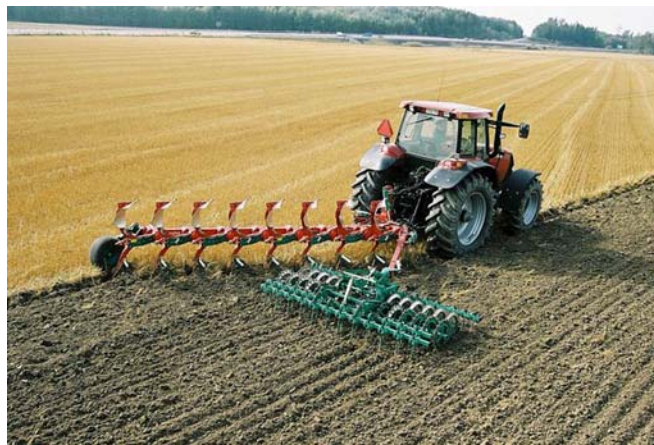
12. ábra. Tarlólántás – Kverneland Ecomattal
