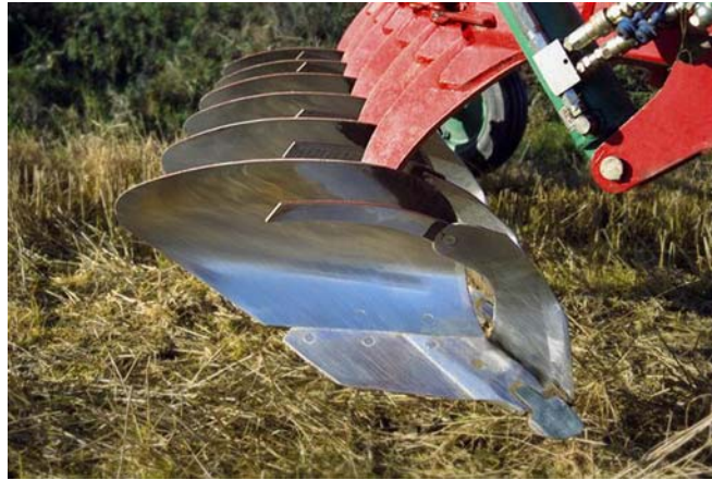
11. ábra. Kverneland Ecomat tarlólántó ekefej 5
