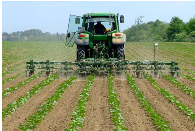
11. ábra. Sorközművelő kultivátor munka közben 9
