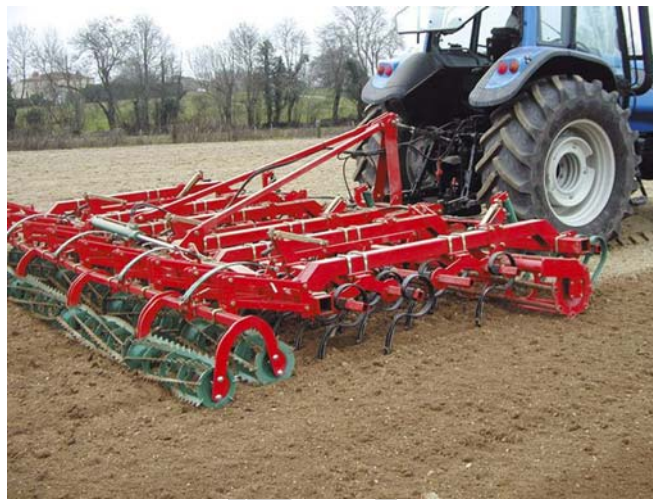
9. ábra. Magágykészítő kombinátor munka közben 6
