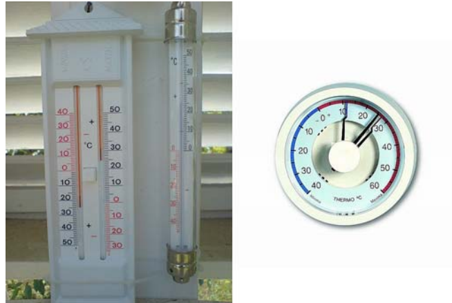
2. ábra. Minimum–maximum hőmérők (folyadéktöltésű 2 és elektromos 3 )
