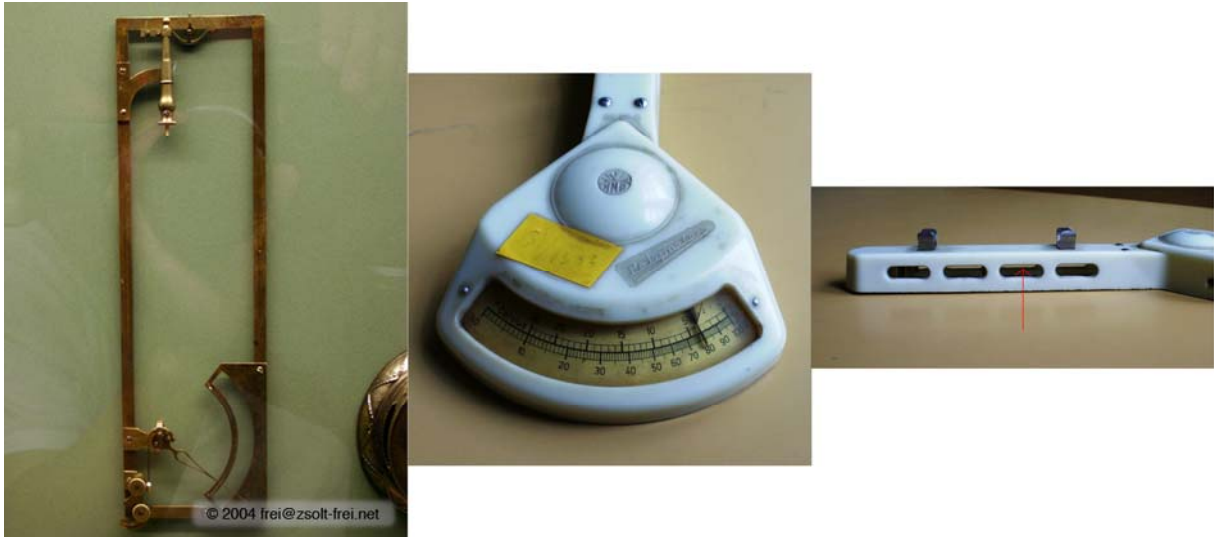
10. ábra. Különböző típusú hajszálas higrométerek 10 (A jobb oldali képen a nyíl a hajszálnyaláb elhelyezésére mutat)
