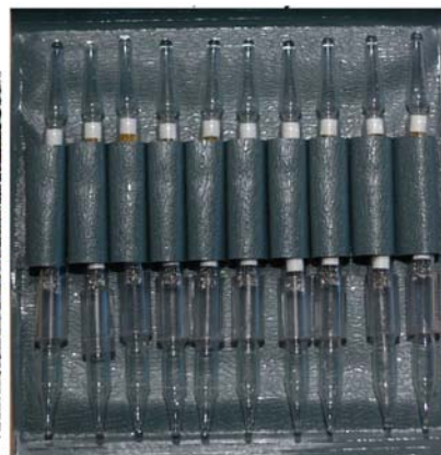
9. ábra. Hagyományos alkoholszonda és használati utasítása
