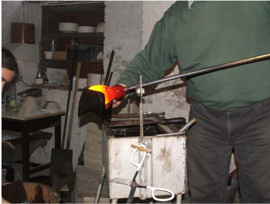
4. ábra. Üveg formázása kanalazással
