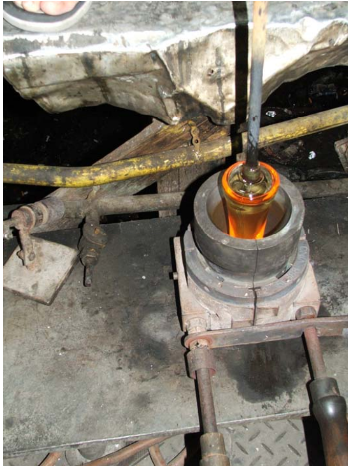
5. ábra. Befújás készformába
