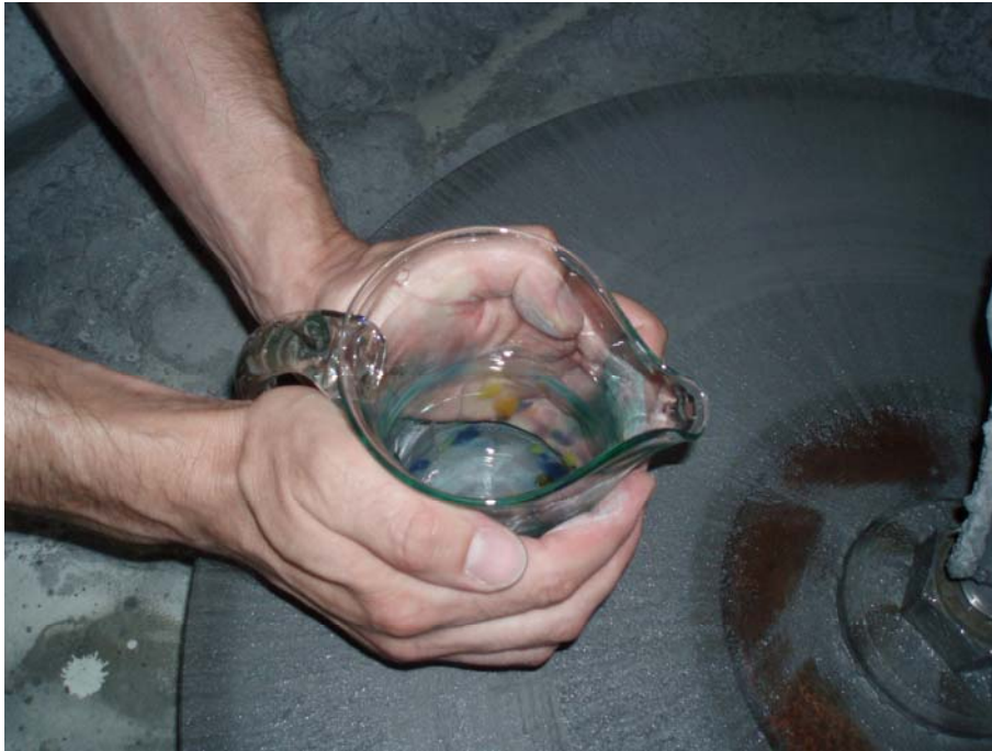
13. ábra. Talpmegmunkálás a vaskorongos durvacsiszoló-gépen 6
