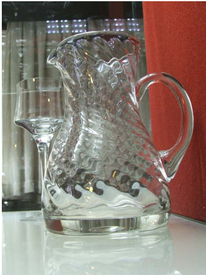
5. ábra. "Optisch" üveg kancsó talpán a ragasztási nyom eltüntetésére szolgáló fenékgolyó
