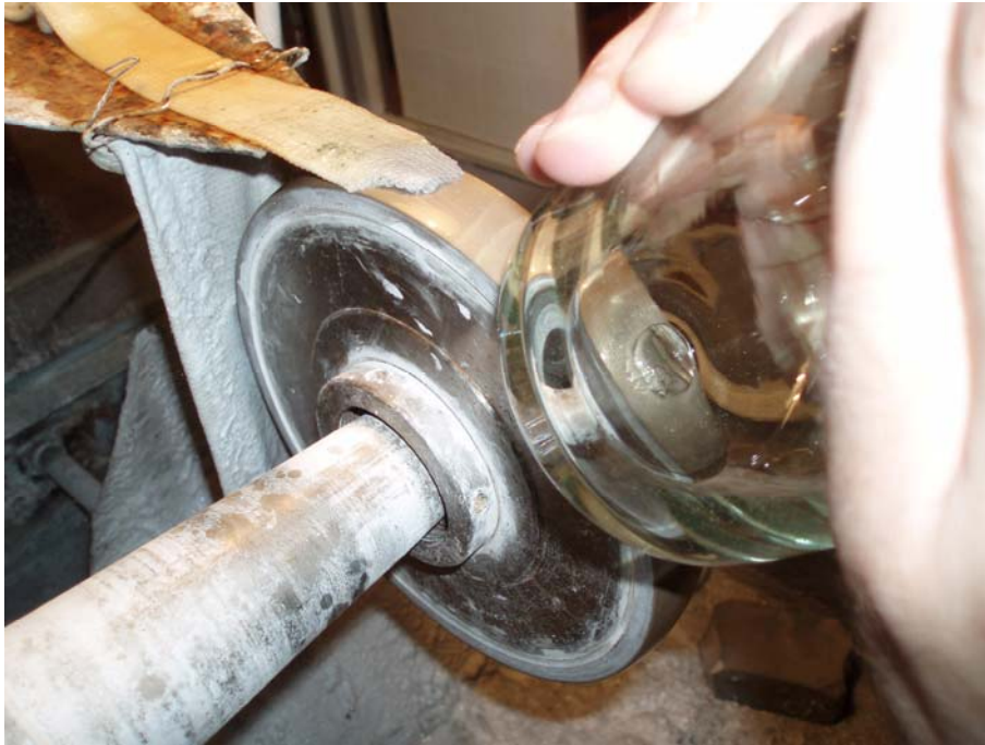
6. ábra. Fenékgolyó kialakítása gyémántkorongon 4
