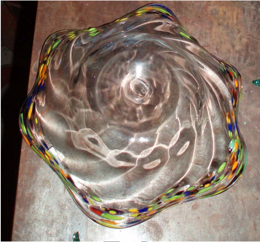
4. ábra. Ragasztási nyom a tartóvas leütése után 3
