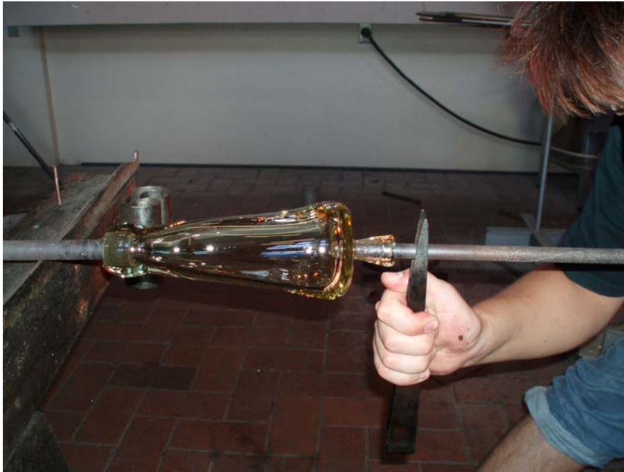
2. ábra. Tartóvas felerősítése a száj kialakításához 1
