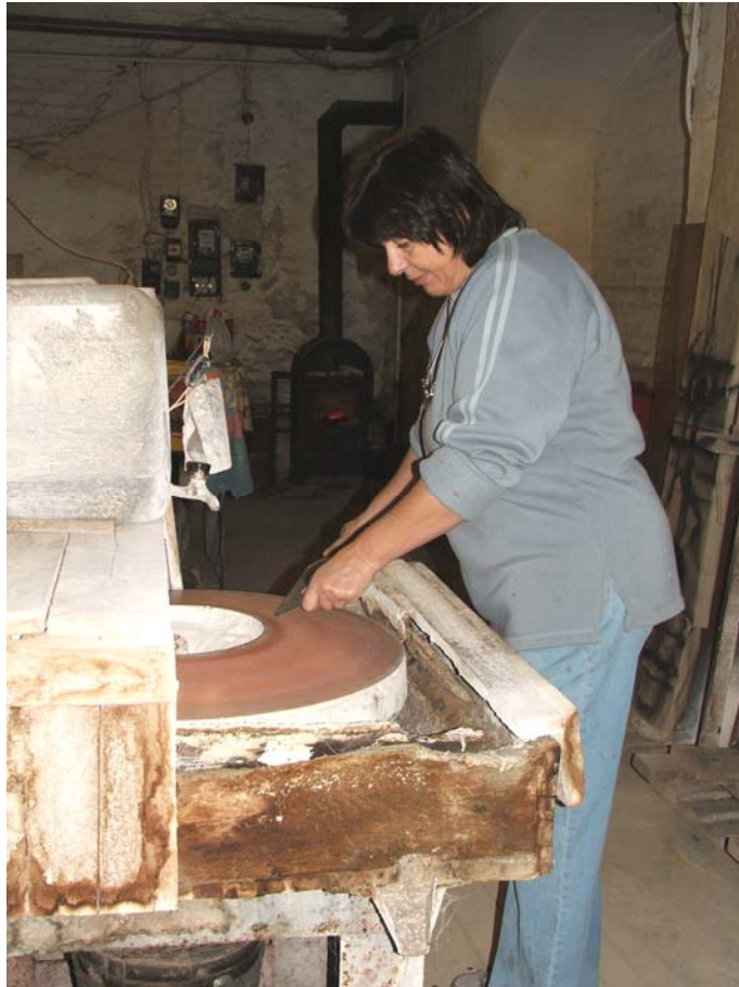
2. ábra. Él kialakítása kőkorongos durvacsiszoló-gépen
