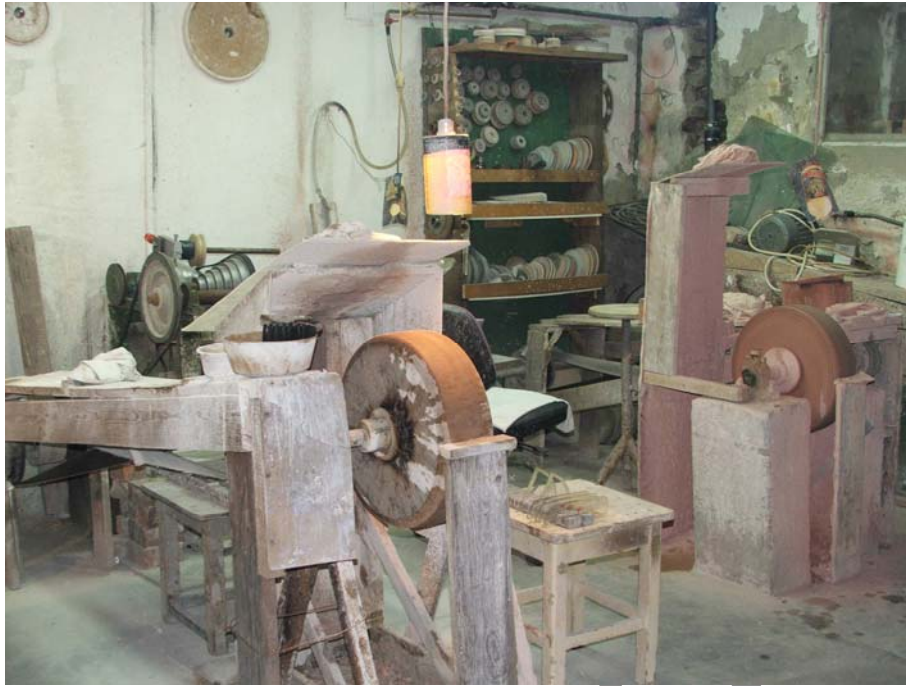
9. ábra. Fazetta fényezésére szolgáló fényezőgépek
