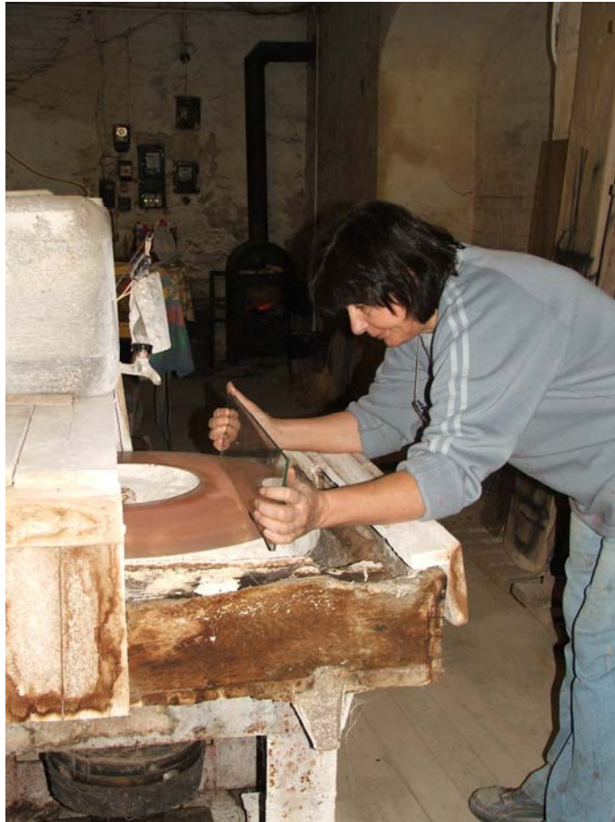
5. ábra. Üvegtábla szélének csiszolása
