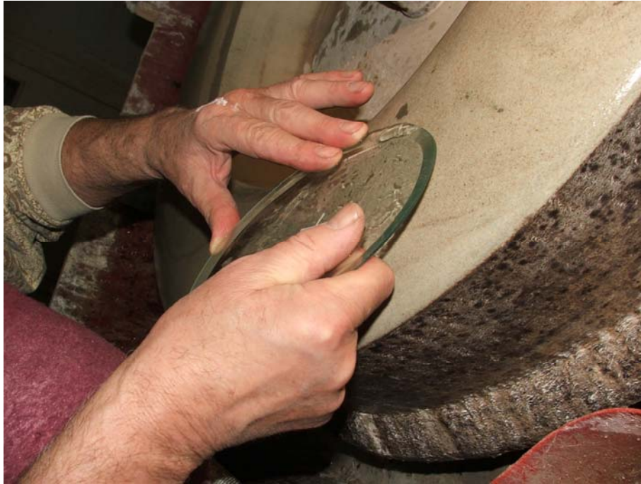
8. ábra. Fazetta finomítása terméskövön
