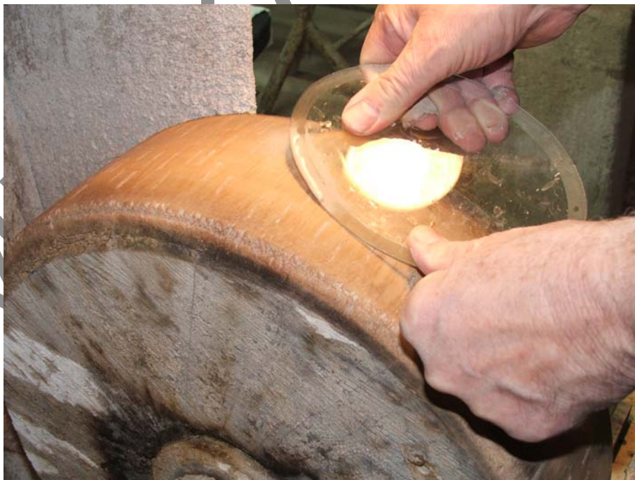
10. ábra. Fazetta durvafényezése hársfakorongon
