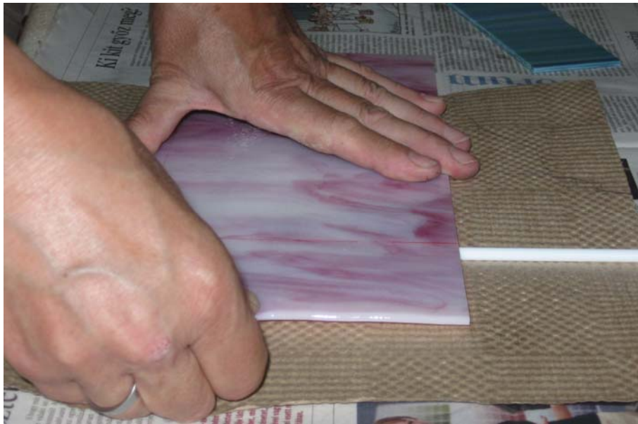
8. ábra. Leválasztás alátámasztással
