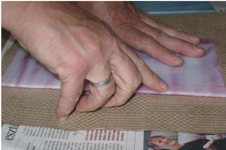
10. ábra. Keskeny csík leválasztása alátámasztással
