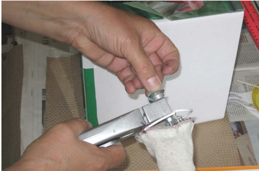
14. ábra. Kis méretek letérése csipkedő fogóval (a letört hulladék a vászonzacskóba esik)
