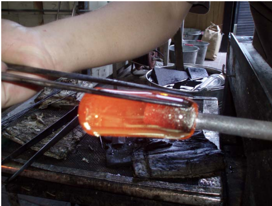
4. ábra. Dugó anyagának tömörítése 4
