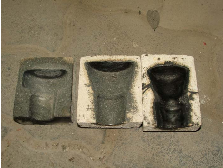
6. ábra. Dugó készítésére használható kőforma 6
