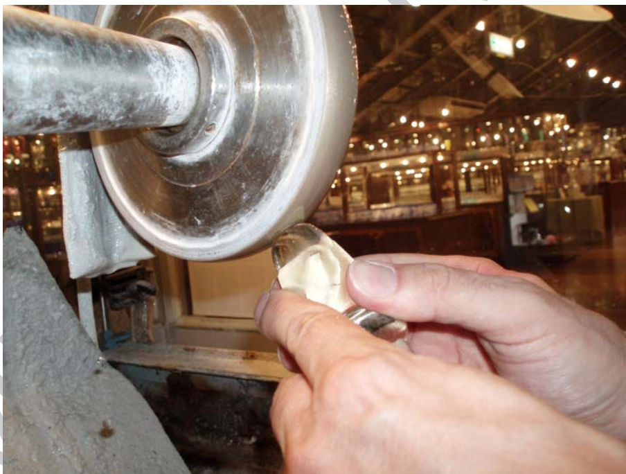
13. ábra. A dugó fenékrészének síkra csiszolása finomcsiszológépen 11
