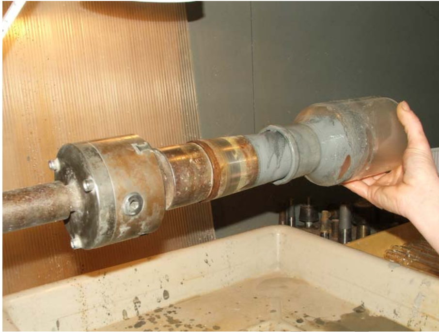
16. ábra. Porüvegnyak becsiszolása
