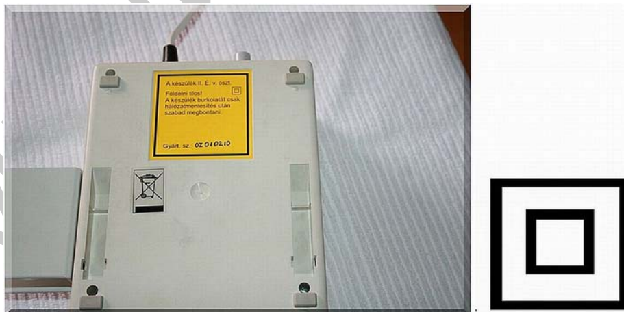
18. ábra. Kettős szigetelés jelölése a készülék adattábláján
