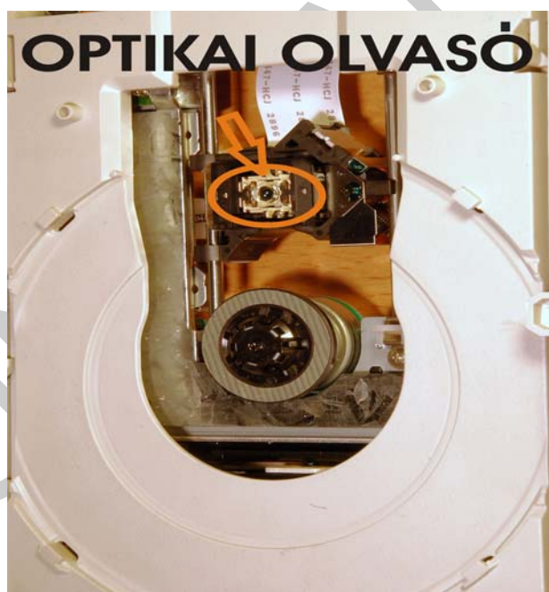
10. ábra. A képen egy CD-meghajtó optikai olvasó egysége látható
