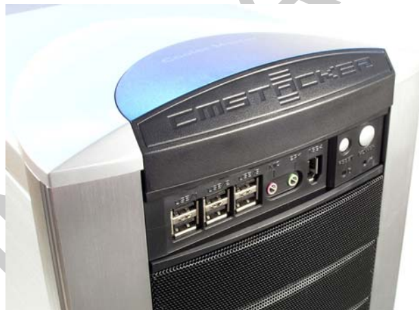
7. ábra. Előlapra kivezetett USB, Audió és Firewire csatlakozók
