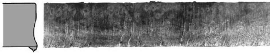
23. ábra. A lángvágás során alkalmazott fúvóka koszos
