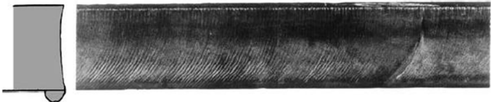
18. ábra. Túl magas lángvágási sebesség
