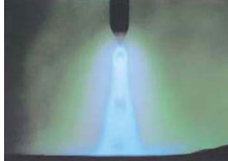
5. ábra. Permetszerű csepp átvitel (Elsősorban szerkezeti acélok ívvel történő hegesztésekor alkalmazzák)
