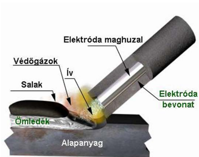
3.ábra. Kézi ívhegesztés vázlata
