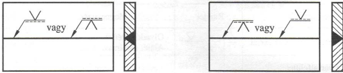
24. ábra. Rajzjel a varrat láthatóságának függvényében (Varrat a nyíl felőli oldalon. Látható - Varrat a másik oldalon, takart)
