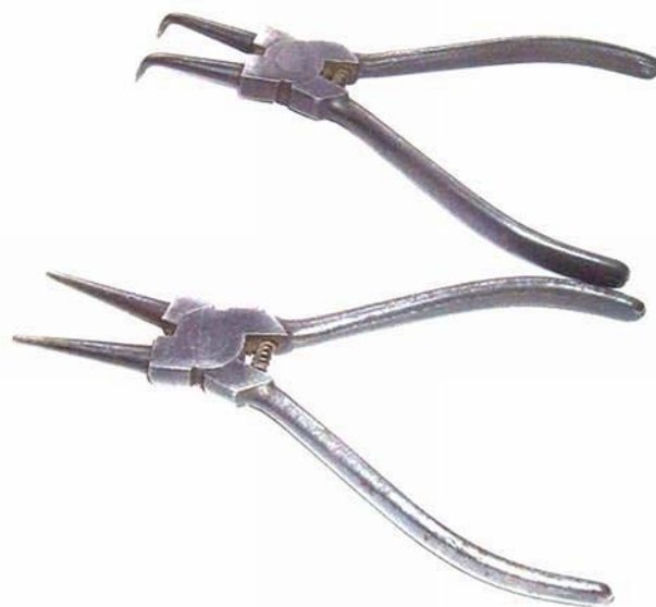
14. ábra. Rögzítőgyűrű (seeger gyűrű) fogó tengelyre
