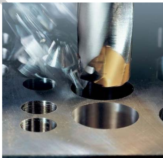
1. ábra. Furatmegmunkálás gépi keményfém lapkás szerszámmal
