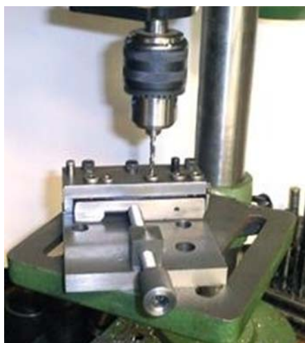
5. ábra. Furatok készítése 5
