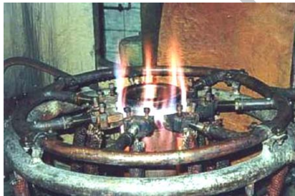
13. ábra. Láingedző berendezés, a lánggyűrű alatt van a hűtőzuhany
