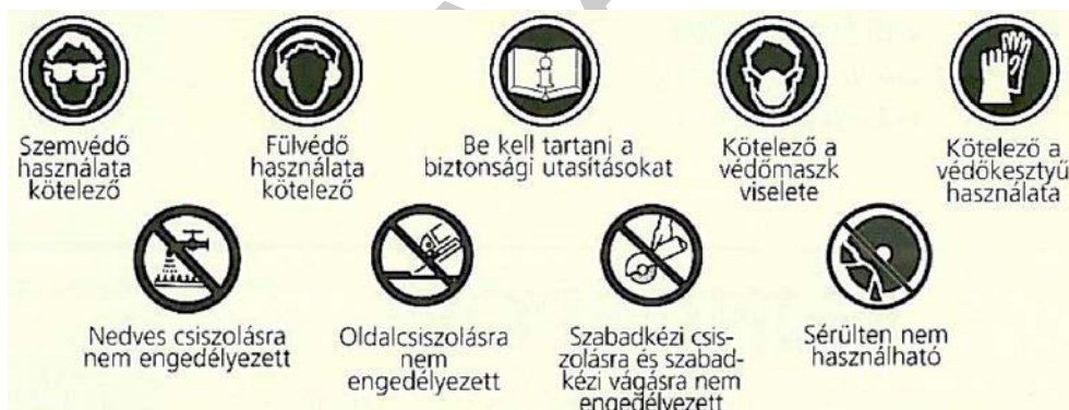
9. ábra. Jelölések értelmezése a köszörű- és vágótárcsákon
