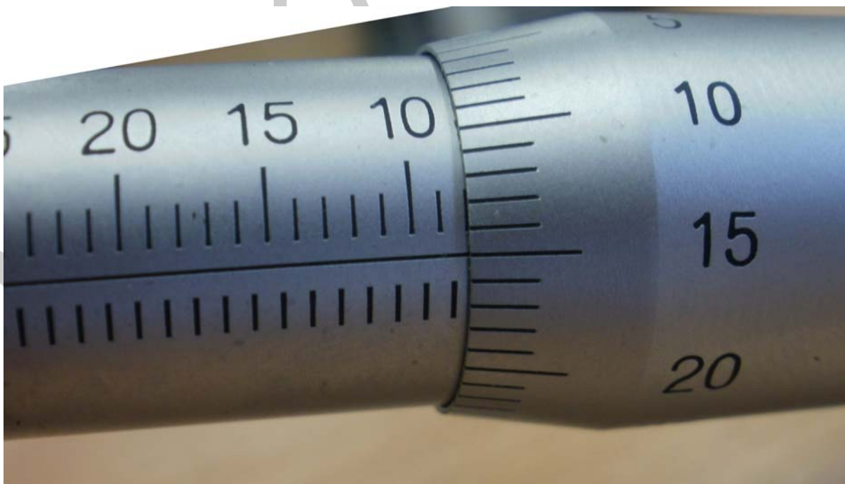
19. ábra: Mélységmérő mikrométer nóniusz osztása
