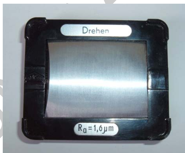
12. ábra. R_a 1,6-os érdesség minta
