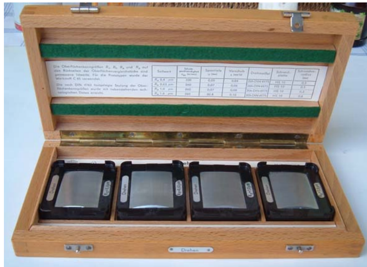
11. ábra. Felületi érdesség minták fadobozban
