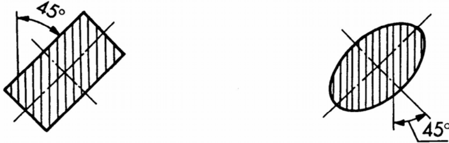
17. ábra. 45°-os kontúrokkal, illetve középvonallal rendelkező alkatrészek vonalkázása
