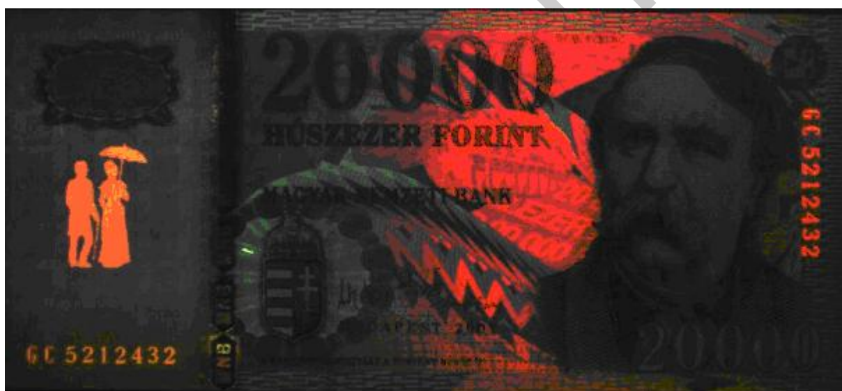
21. ábra. UV-C fényben vörös színben világít a motívum illetve a függőleges sorozatszám 20
