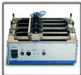
4. ábra. Kopásállóság, súrolás és moshatóság vizsgáló készülék 5
