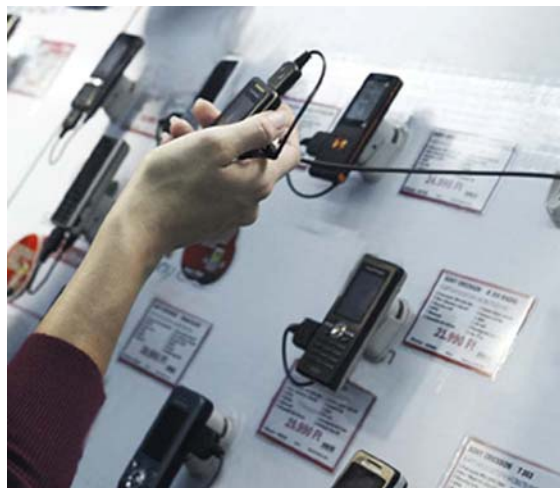
31. ábra. Vezetékes áruvédelmi rendszer 29
