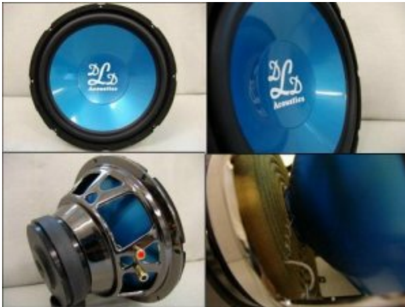
16. ábra. Példa egy 30 cm-es mélynyomóra, több nézetből
