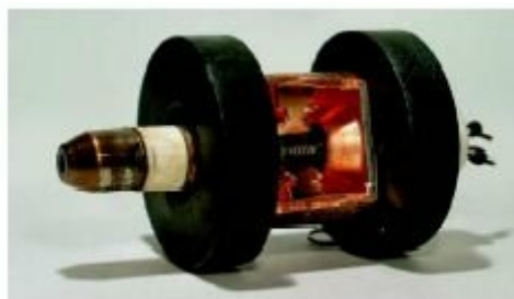
15. ábra. A magnetroncső 15
