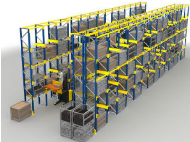
14. kép Egyapalettás soros állvány – Jungheinrich 14
