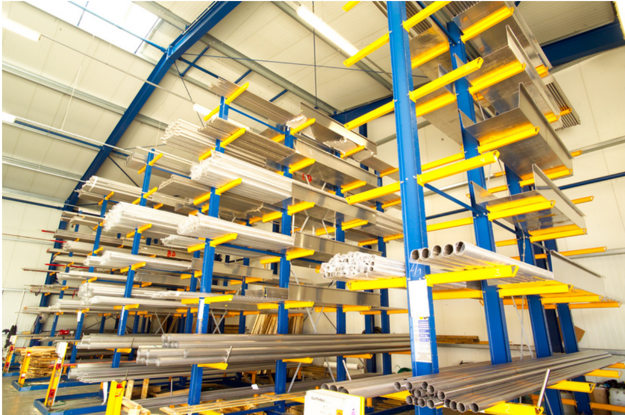
19. Kép Szálas anyagok tárolása Jungheinrich karos állványokon 21
