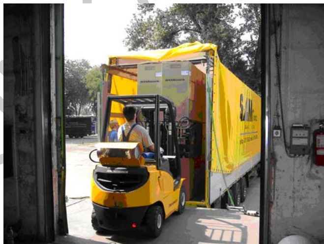
2. ábra: Kirakodás targoncával kiépített rakodón keresztül
