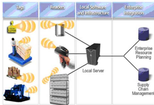
12. ábra: RFID rendszer működése és infrastruktúrája
