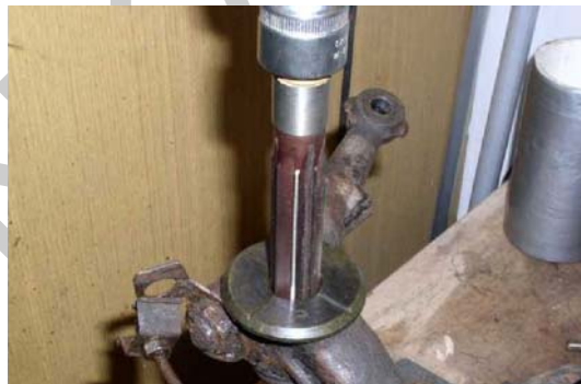
3. ábra. Autóalkatrész furatának felújítása dörzsárral
